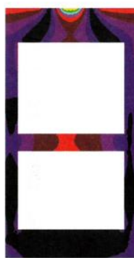
Obr. 6: Pole ekvivalentních teplotních napětí HMH plynového hořáku chlazeného zemním plynem a vzduchem. Platí řez procházející otvorem pro výstup paliva do spalovacího prostoru. Napětí jsou uvedena v MPa.
