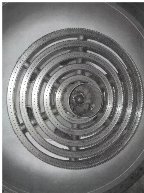
Obr. 2: Foto kruhového hořáku pro mikrodifúzní systém spalování
