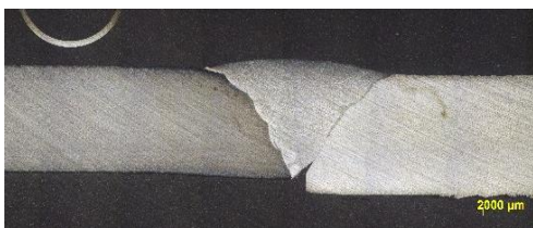
Obr. 8: Makrofotografie metalografického výbrusu – vzorek A s vadou typu neprůvar v kořeni.
