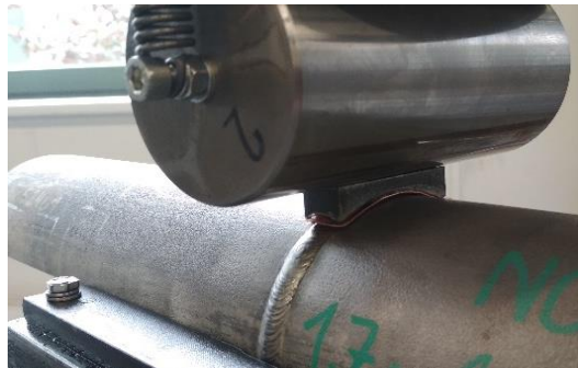
Obr. 7: Příklad způsobu aplikace cyklické mechanické zátěže svarového spoje
