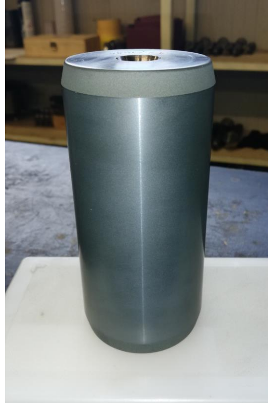
Obr. 4: Zkušební kus obrobeným žárovým nástřikem
