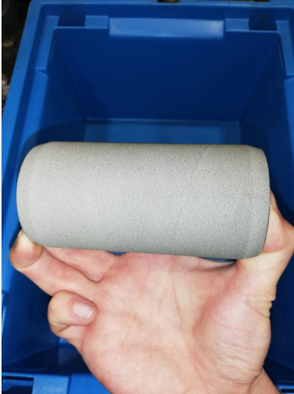
Obr. 3: Zkušební kus s provedeným žárovým nástřikem
