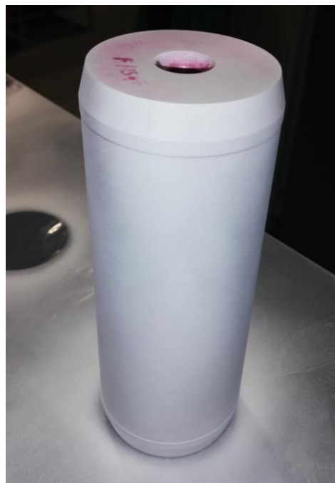
Obr. 2: Zkušební kus po vyhovující kapilární kontrole
