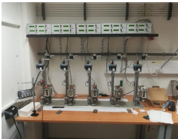
Obr. 7. Technologické zařízení k obnově primární ochrany vláken polyimidem pro průmyslové senzory s FBG
