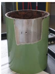
Obr. 7: Těleso pro zkoušení „zatékavosti“ povlaku zhotoveného technologií CS
