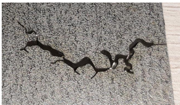
Obr. 2: Příklad trhlíny v tělese vyrobené drátořezem
