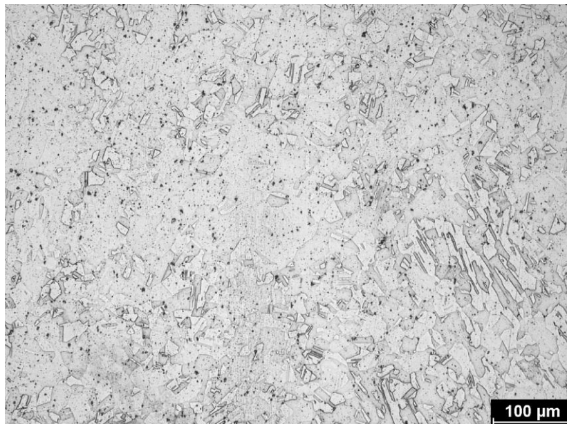
Obr. 1: Mikrostruktura dodané oceli SUPER 304H (světelný mikroskop)
