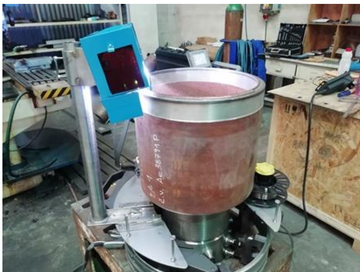
Obr. 6: Navařování návaru a provedení svarového spoje automatem
