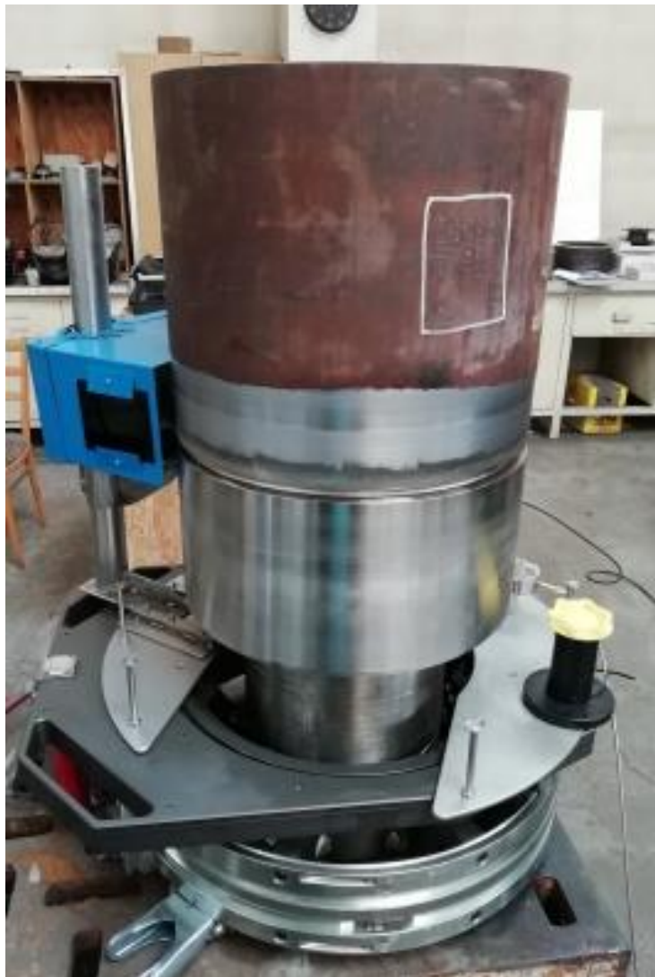
Obr. 5: Navařování návaru a provedení svarového spoje automatem
