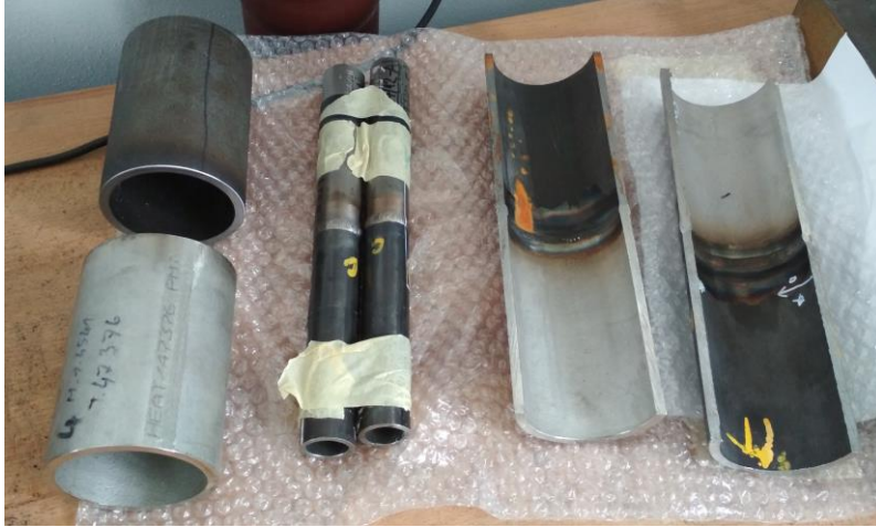
Obr. 1: Dodané vzorky a materiál pro výrobu zkušebních těles nátrubků N6 a N7
