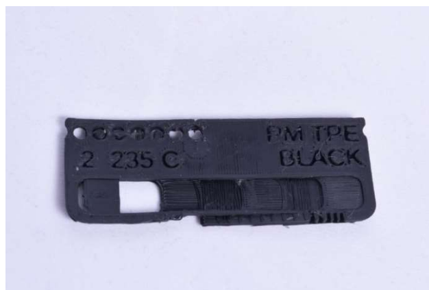
Obrázek 21: TPE - testovací destička (Zdroj: Vlastní)
