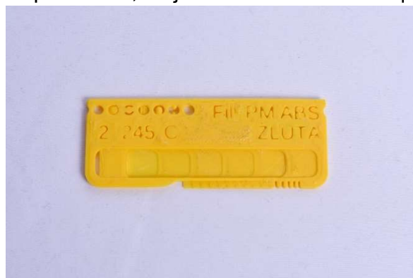
Obrázek 17: ABS - testovací destička (Zdroj: Vlastní)
