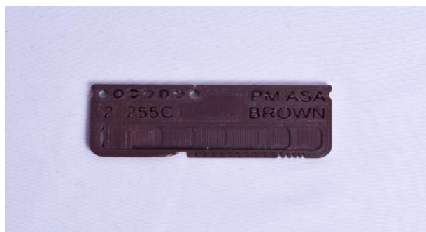
Obrázek 19: ASA - testovací destička (Zdroj: Vlastní)
