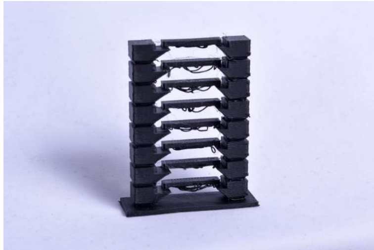
Obrázek 20: TPE – teplotní věž (Zdroj: Vlastní)
