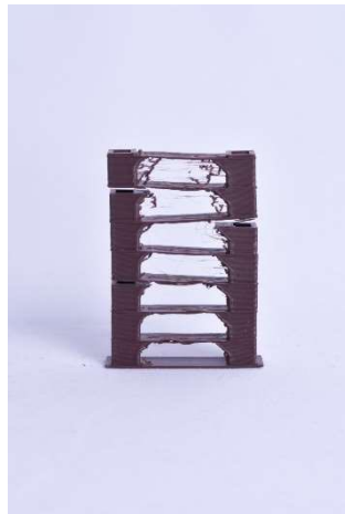
Obrázek 18: ASA - teplotní věž (Zdroj: Vlastní)
