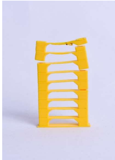
Obrázek 16: ABS – teplotní věž (Zdroj: Vlastní)
