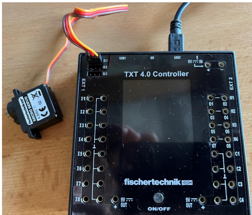
Obrázek 2-12: Servomotor – ukázka zapojení na výstup S1
