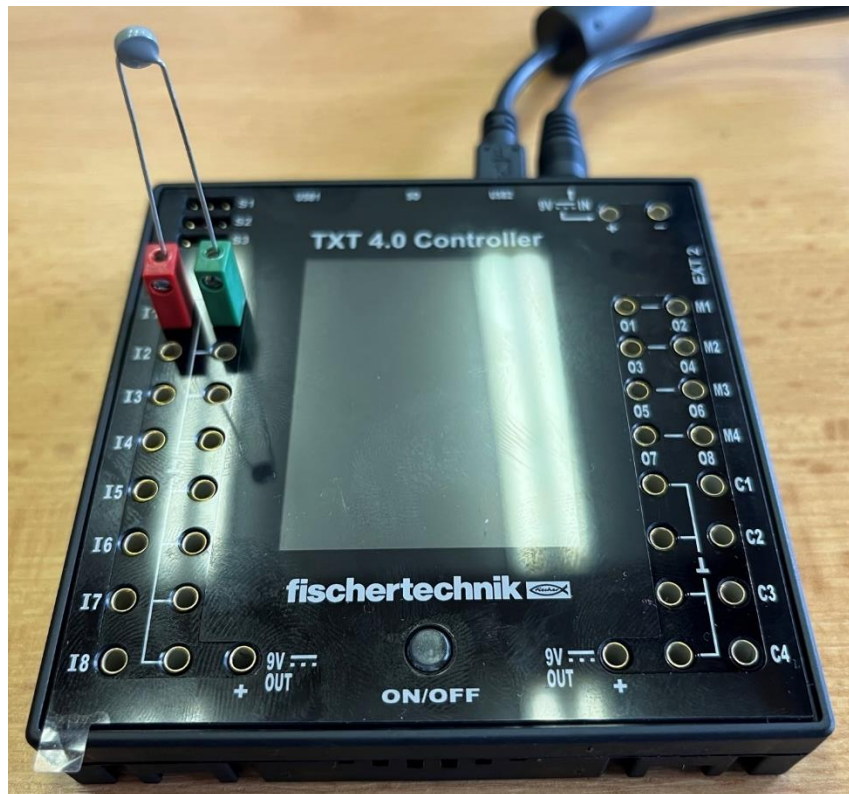
Obrázek 2-24: NTC rezistor – ukázka zapojení na vstup I1
