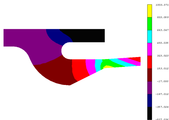
obr. 5: Detail pole obvodových napětí v segmentu plamence spalovací komory chlazeného závojem chladicího vzduchu Napětí jsou uvedena v MPa.
