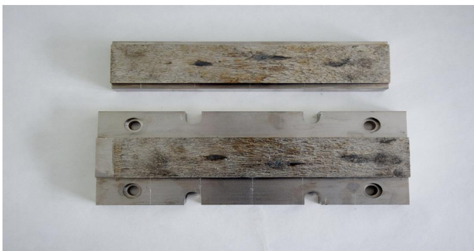
Obr. 4 Třecí plocha zkušebních vzorků po ukončení zkoušky č. 3
