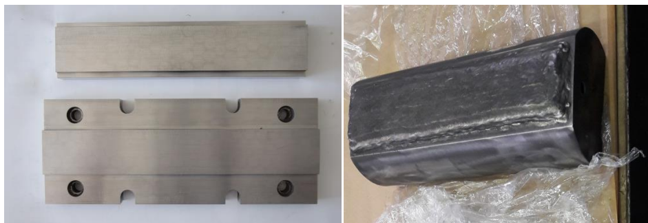
Obr. 3. : Konečný tvar vzorku s návarem
