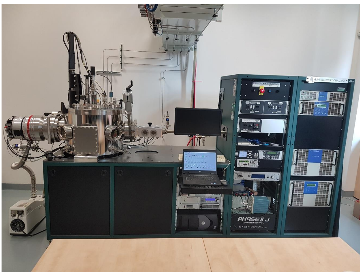
Obr. 4.1 Depoziční aparatura ATC 2200-V od společnosti AJA International Inc. používaná na Katedře fyziky FAV ZČU.
