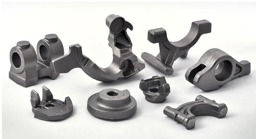
Obr. 7 Příklady odlitků určených k obrábění [12]
