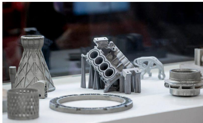
Obr. 1 Ukázka dílů vyrobených pomocí 3D tisku [2]
