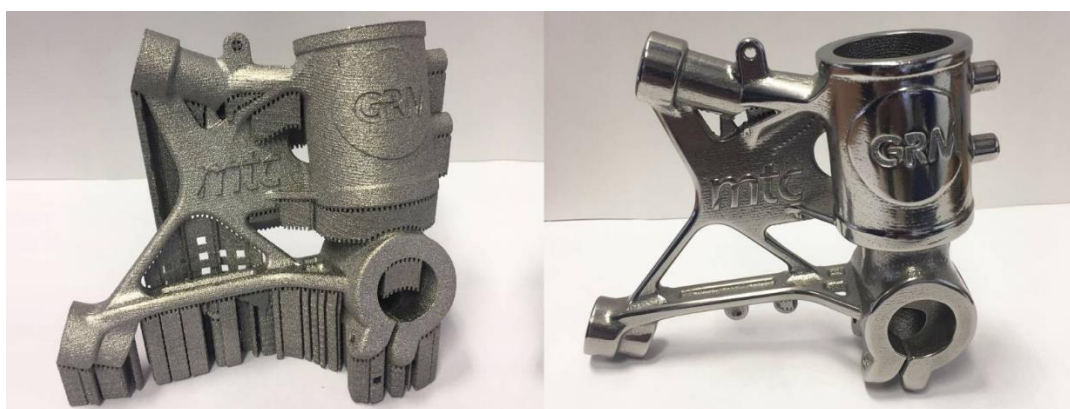
Obr. 11 Ukázka tištěného dílu před a po postprocesingu [17]
