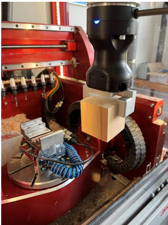
Obr. 60, 61 – Přejezd robotu pohybem J na hranici obráběcího stroje, následně se stejným pohybem dostane do přípravné pozice nad svěrák (nezobrazeno) a pohybem L vloží polotovar do svěráku.
