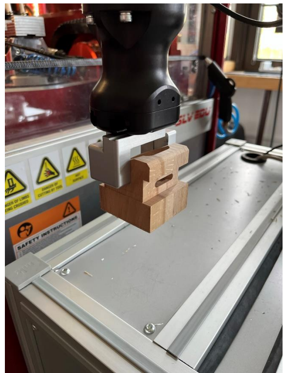
Obr. 64, 65 – Uchopení hotové součásti robotem a odjezd mimo oblast obráběcího stroje.
