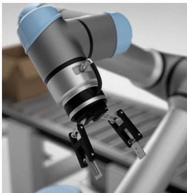
Obr. 11, 12, 13 – Příklady různých koncových efektorů, zleva: kleště, dávkovač technologické tekutiny, přísavka. [23], [24], [25]
