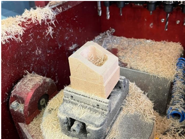
Obr. 44, 45 – Součást po obrobení vnitřní kapsy a hrubování zkosení horní plochy. Jsou patrné stopy po řádkování zkosení. Vpravo totožná operace v simulaci v CAMu. Tyrkysová barva označuje plochy obrobené nástrojem F10.
