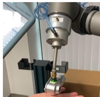
Obr. 11, 12, 13 – Příklady různých koncových efektorů, zleva: kleště, dávkovač technologické tekutiny, přísavka. [23], [24], [25]
