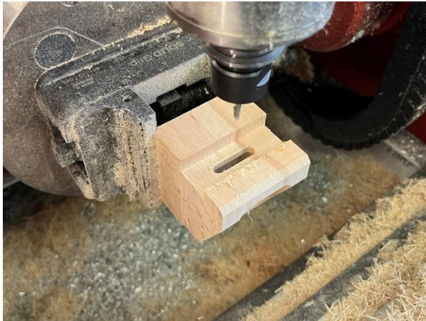
Obr. 47, 48 – Součást po obrobení levé stěny. Na přední straně je vidět již na čisto obrobené sražení. Vpravo totožná operace v simulaci v CAMu. Fialová barva označuje plochy obrobené nástrojem F4.
