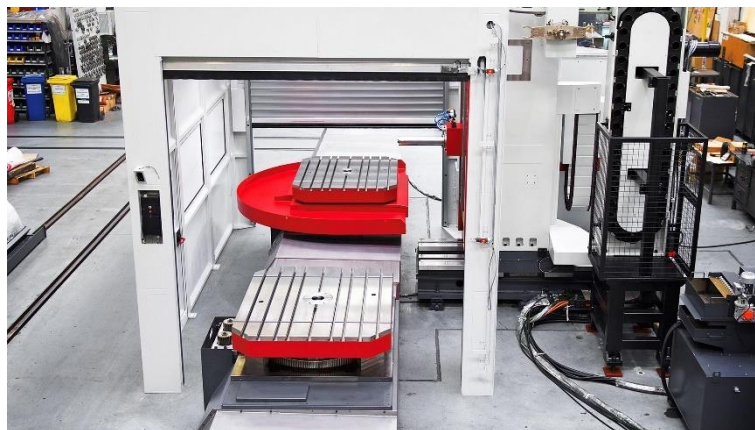
Obr. 25 – Ukázka paletového systému automatizované výměny obrobků. [37]
