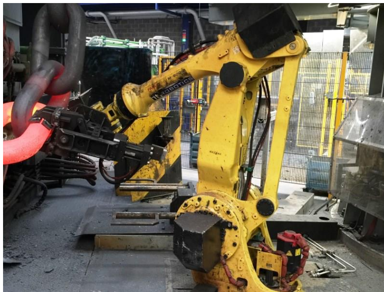
Obr. 23 – Použití manipulátoru při kovářském svařování článků lodního řetězu. [34]
