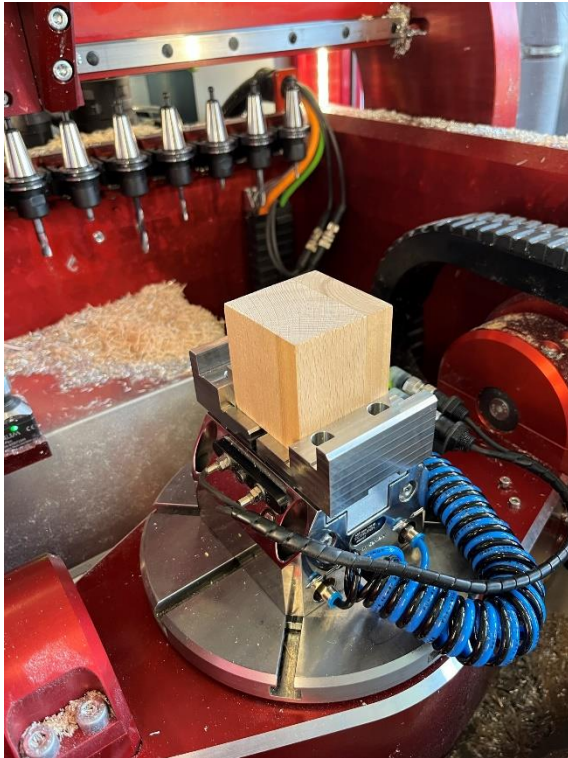
Obr. 62, 63 – Polotovár a hotová součást ve svěráku. Součást je zobrazena již po předání řízení robotu, ve chvíli, kdy robot již provedl nájezd do přípravné pozice nad svěrákem – součást proto již není do svěráku upnutá.
