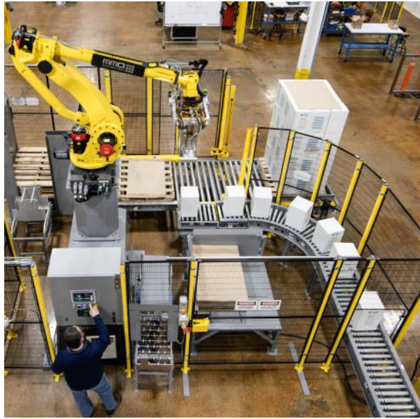
Obr. 20 – Typické společné využití robota typu RRR a dopravníkového pásu. [31]
