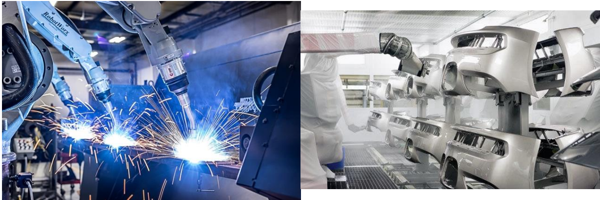
Obr. 21, 22 – Ukázky použití robotů v aplikacích mimo oblast obrábění – obloukové svařování a stříkání nátěrových hmot. [32], [33]
