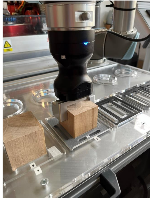
Obr. 58, 59 – Nájezd kleští do polohy nad polotovarem na pozici 2 – nájezd je proveden pohybem J. Sjezd kleští k polotovaru je proveden pohybem L, následuje uchopení polotovaru.
