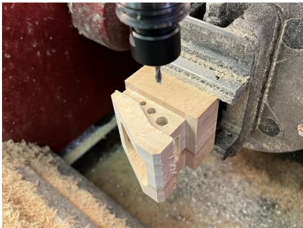
Obr. 49, 50 – Obrábění nejsložitější strany – drážka s nekonstantním průřezem a díry různých průměrů. Díry byly předvrtány jedním vrtákem a následně rozšířeny frézováním, aby se ušetřila výměna nástrojů. Vpravo simulace frézování největší díry v CAMu. Tmavě červená zobrazuje plochy obrobené nástrojem F8, oranžová plochy obrobené nástrojem V4.
