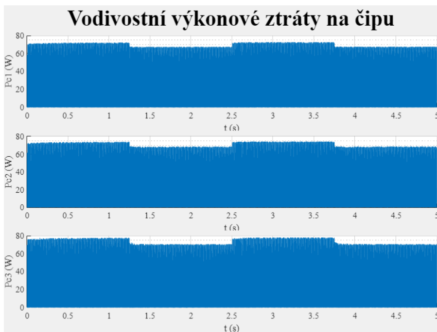
Obr. 2.17 Průběhy vodivostních ztrát součástky SCT3022KLHR pro tři napětí na baterii, S6 rovinka [4]
