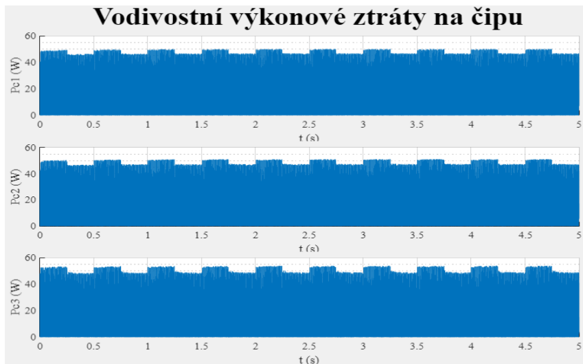
Obr. 2.2 Průběhy vodivostních ztrát součástky BSM120D12P2C005 pro tři napětí na baterii, S6 slalom
