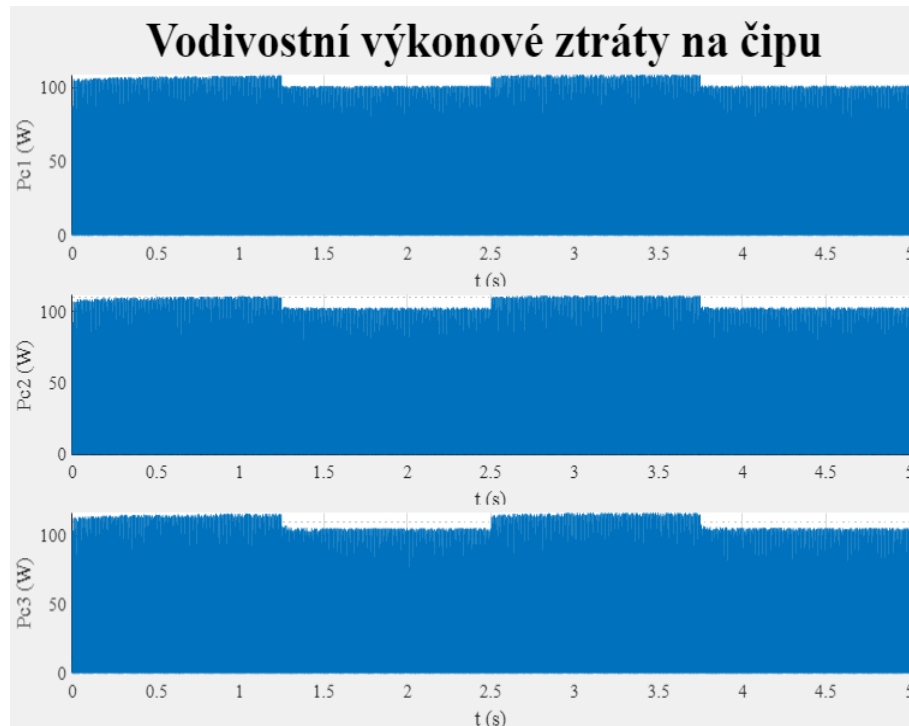
Obr. 2.23 Průběhy vodivostních ztrát součástky CAB016M12FM3 pro tři napětí na baterii, S6 rovinka [4]
