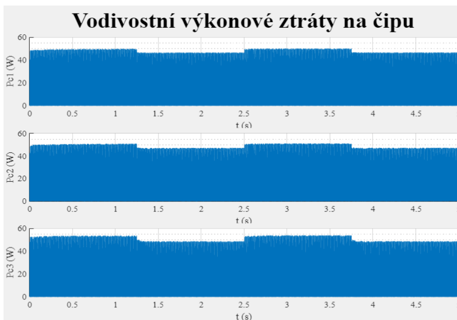
Obr. 2.5 Průběhy vodivostních ztrát součástky BSM120D12P2C005 pro tři napětí na baterii, S6 rovinka [4]
