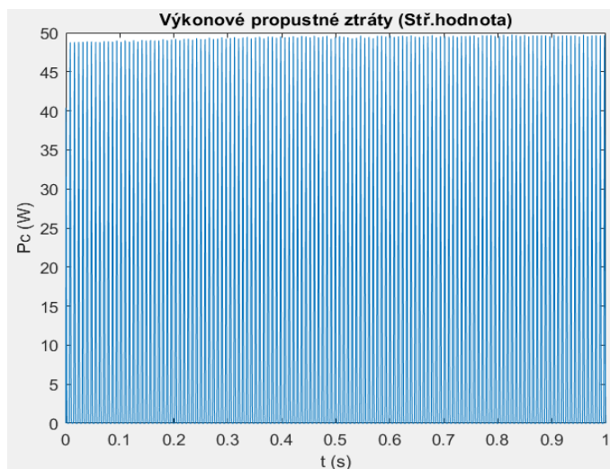
Obr. 1.12 Propustné ztráty tranzistoru při U_{dc\_max} [4]
