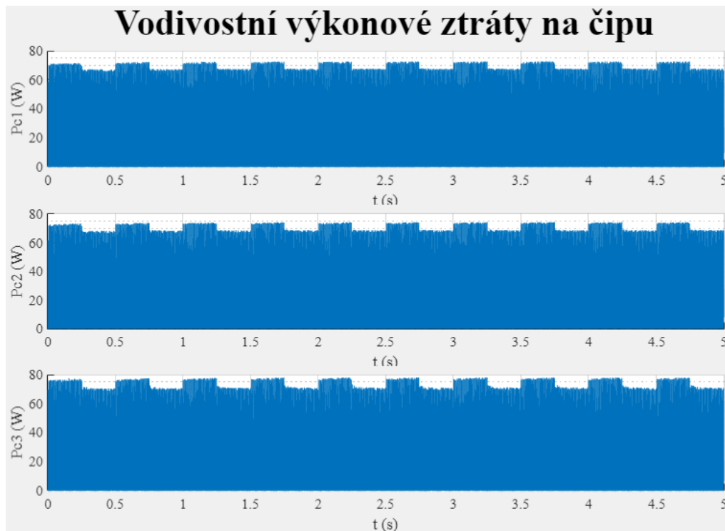
Obr. 2.14 Průběhy vodivostních ztrát součástky SCT3022KLHR pro tři napětí na baterii, S6 slalom [4]
