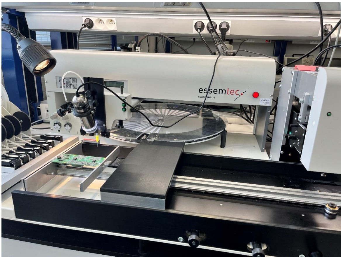
Obr. 4.1 Fotografie poloautomatického osazovacího zařízení s připravenou deskou budičů
