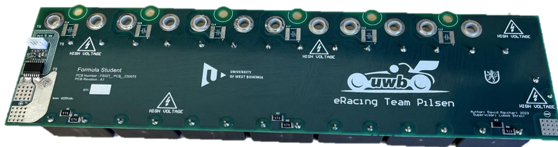
Obr. 4.14 Fotografie plně osazené desky kondenzátorů
