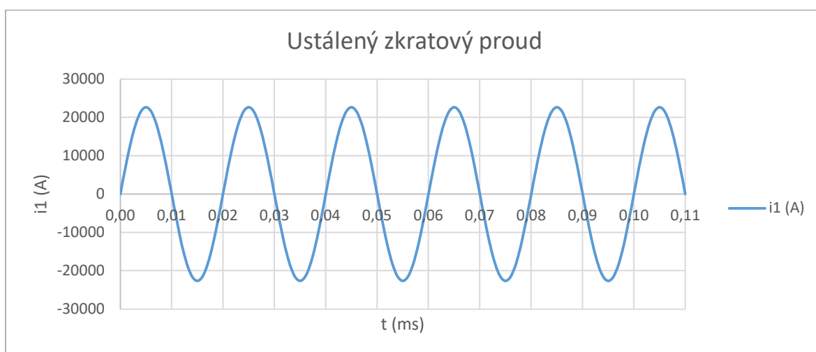
Obrázek 34: Průběh ustáleného zkratového proudu jedné fáze.
