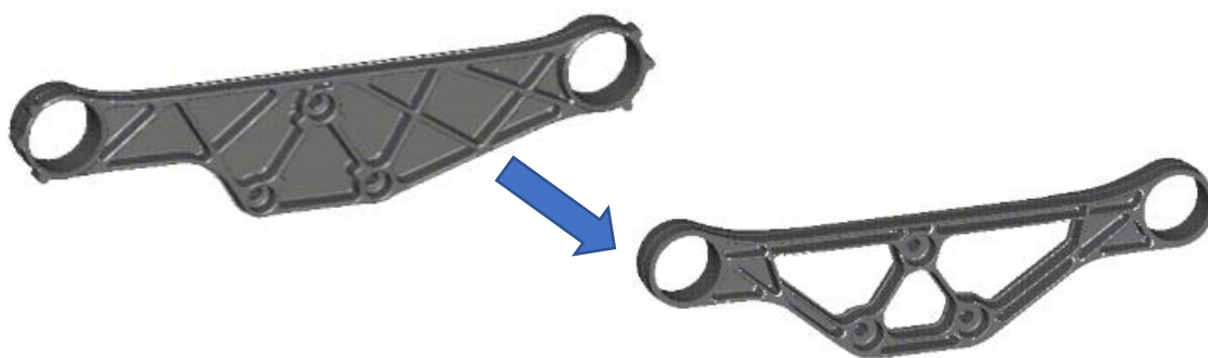
Obr. 22 : Těleso před a po optimalizaci (12)
