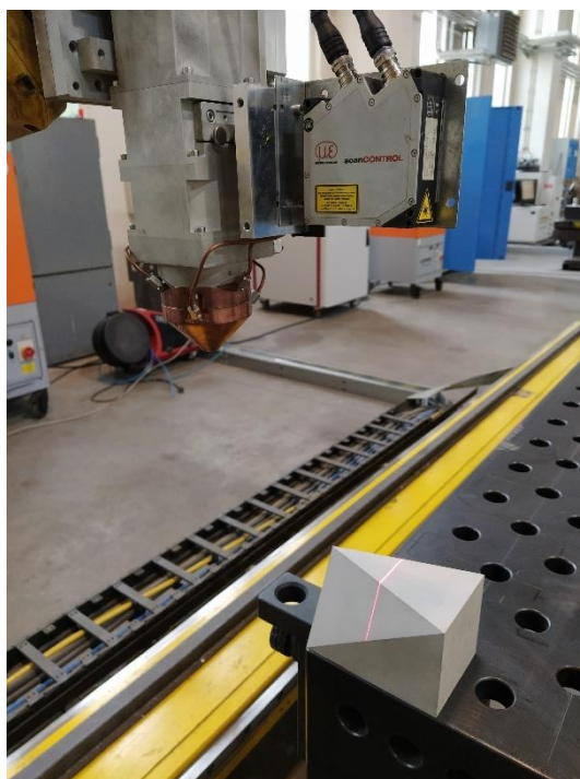
Obr. 8.5: Testování měřených dat profilovým skenerem scanCONTROL 2600-100.
