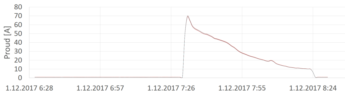
Obrázek 2: Příklad dobíjení DC na hladině nn [9]
