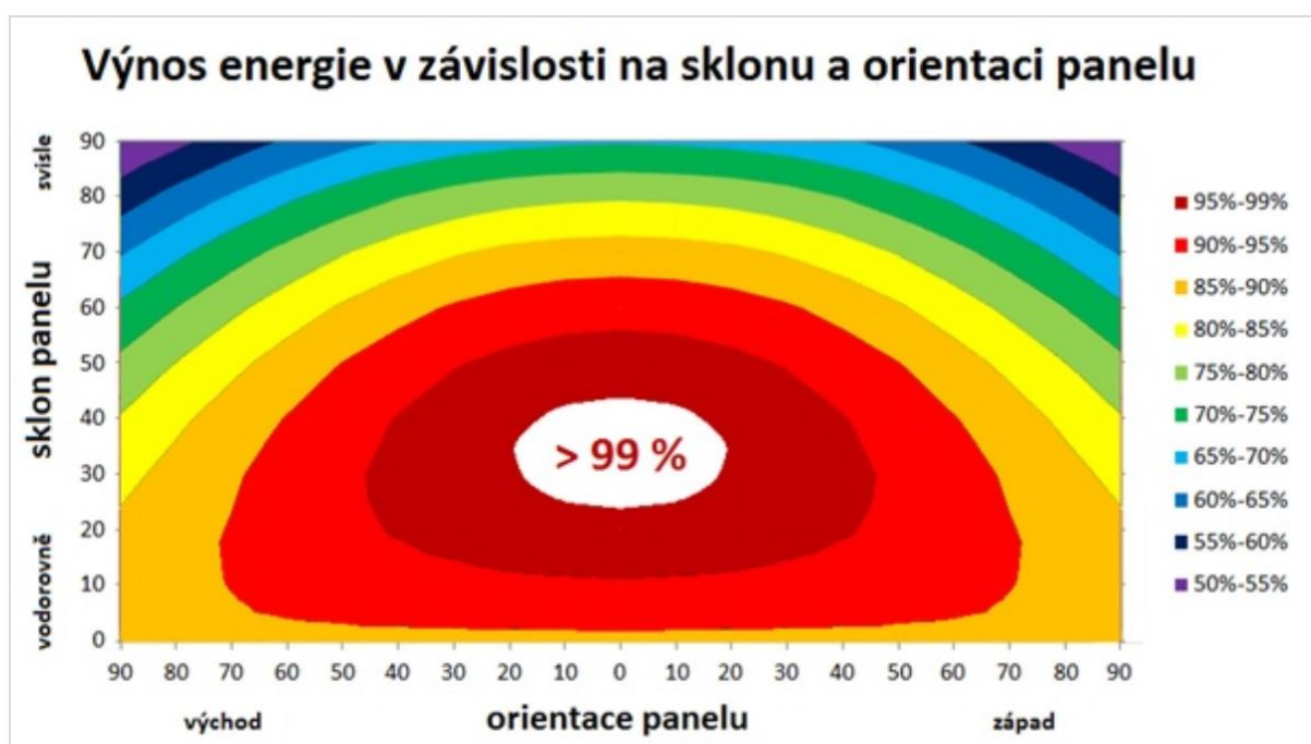
Obr. 8: Výnos energie v závislosti na sklonu a orientaci panelu. [8]
