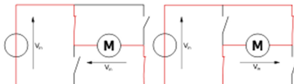
Obr. 13: Princip H můstku [12]
