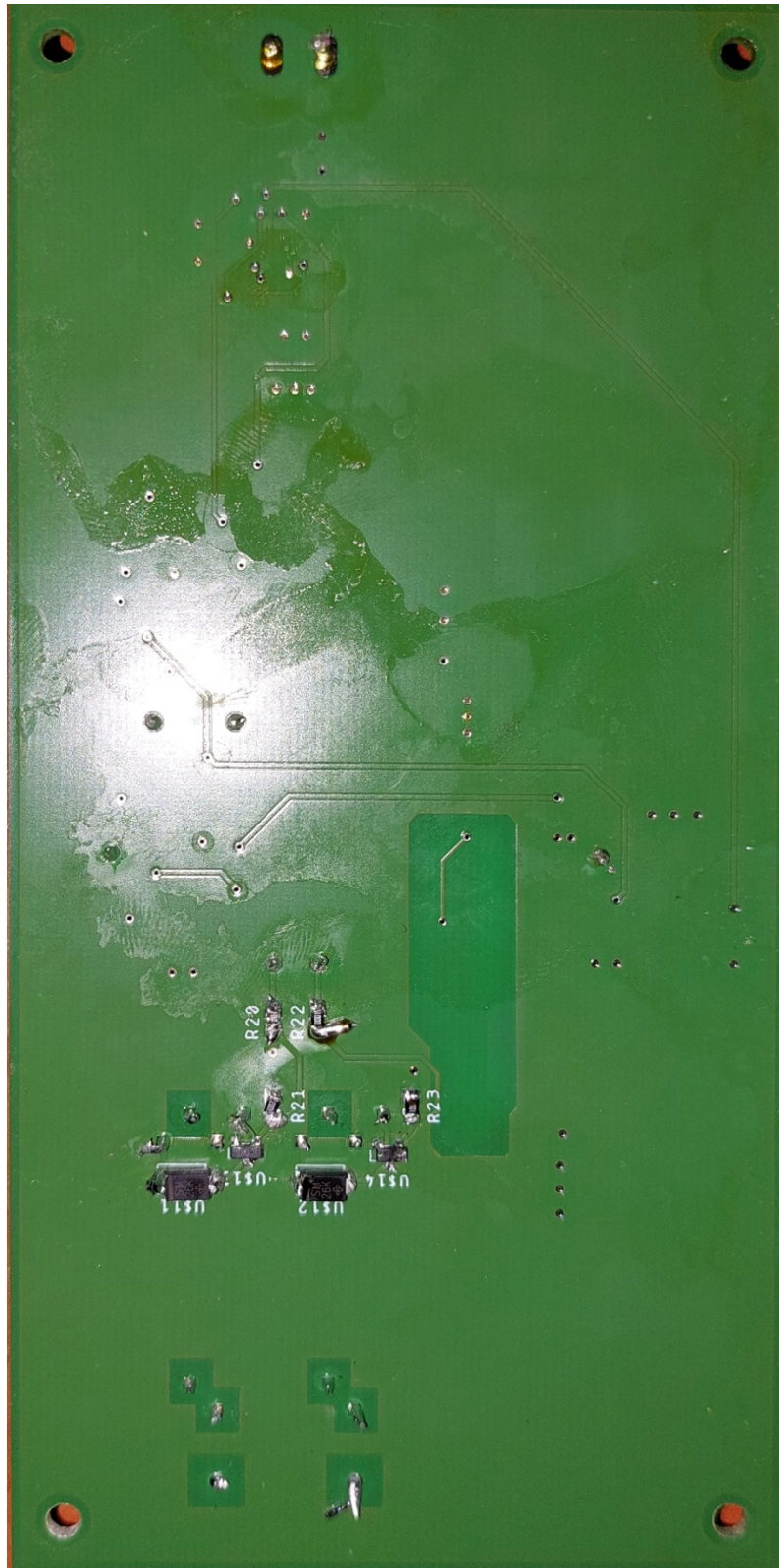
Obr. 36: Osazená PCB bottom strana
