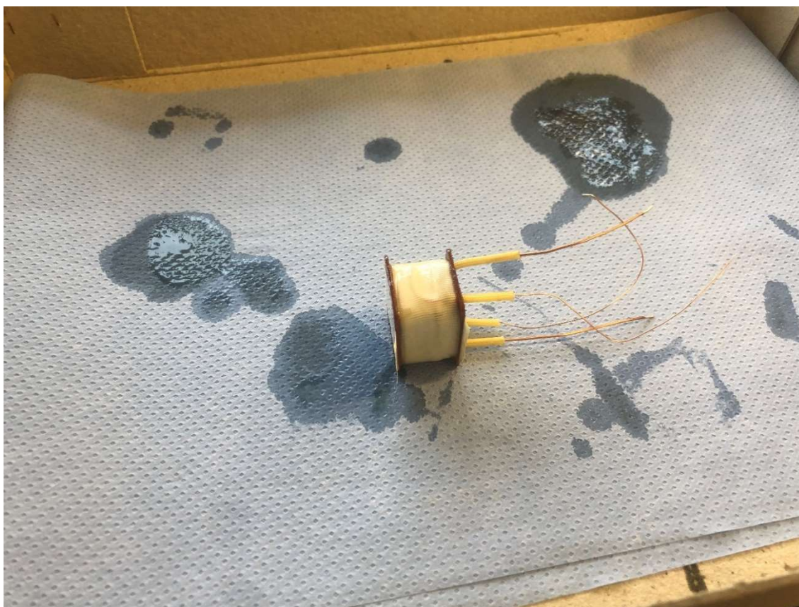
Obrázek 32 – Odsátí přebytečné impregnační pryskyřice
