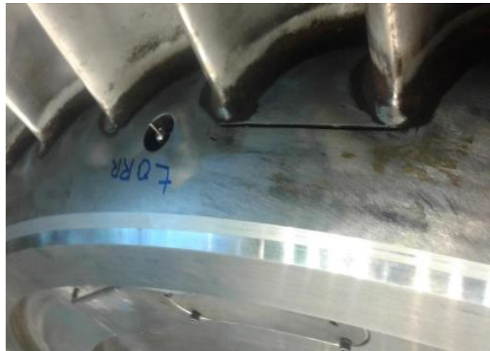
Obrázek 17- Odběr statického tlaku - vpravo, měření teploty teploměrem – vlevo [25]
