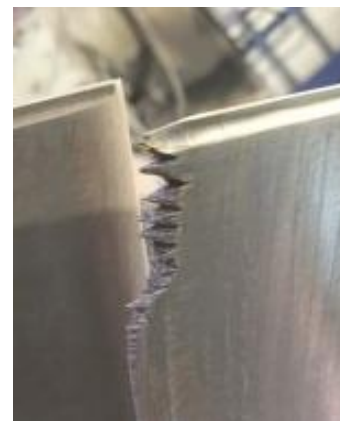
Obrázek 13 - Eroze náběžné hrany na špičce poslední lopatky [9]
