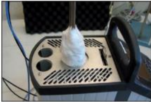
Obrázek 28 - Utěsnění vzduchové mezery při kalibraci teploměru [75]
