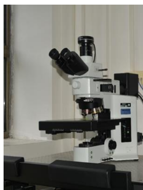
Obr. 7.14: Světelný mikroskop OLYMPUS GX51 [foto: Vojtěch Bílek]
