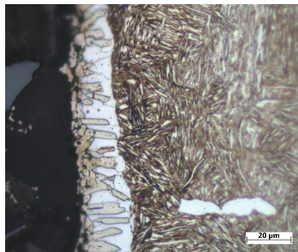
Obr. 7.89: Detail boridové vrstvy vzorku 5Mn_IA_03_B, zvětšení 100x
