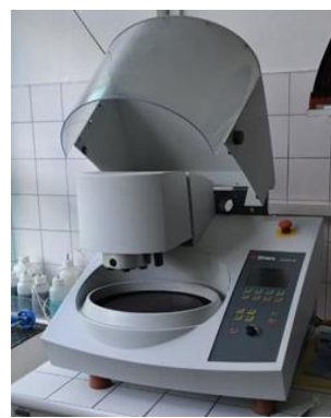
Obr. 7.15: Metalografická bruska/leštička STRUERS TEGRAMIN-30 [foto: Vojtěch Bílek]
