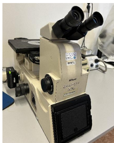
Obr. 7.5: Inverzní mikroskop Nikon EIPHOT 300 [foto: Robert Rupert]
