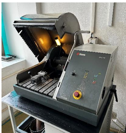
Obr. 7.16: Metalografická pila DISCO-TOM-6 [foto: Robert Rupert]
