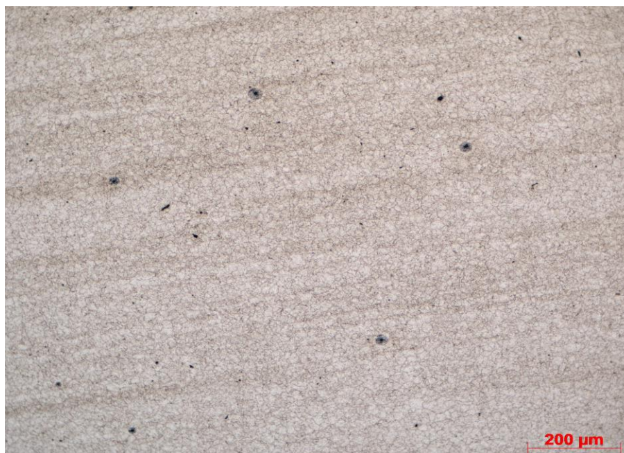
Obr. 8: Výchozí mikrostruktura oceli QRO 90 Supreme (podélný řez), zv. 100x
