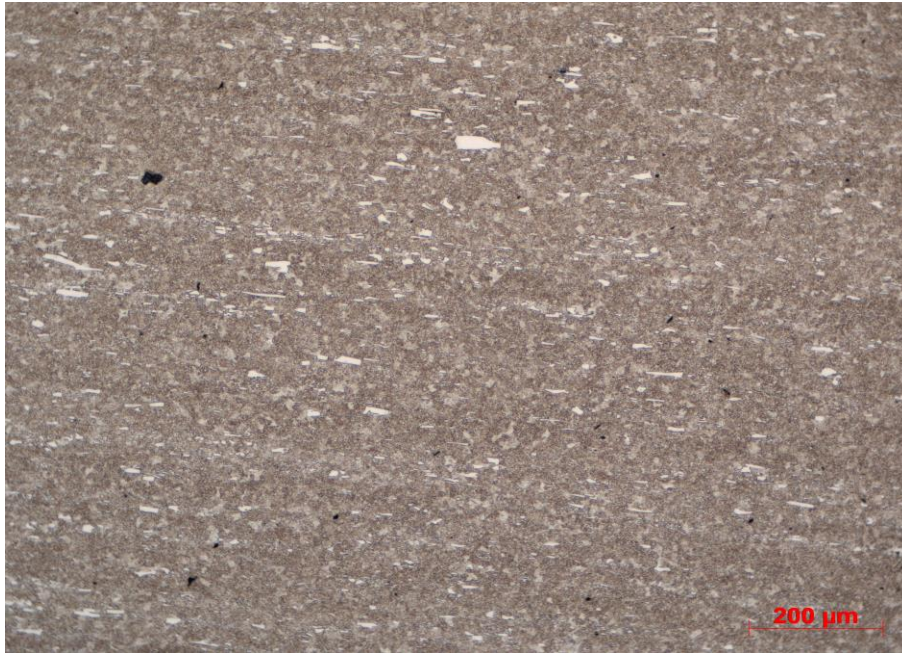
Obr. 6: Výchozí mikrostruktura oceli Sverker 21 (podélný řez), zv. 100x
