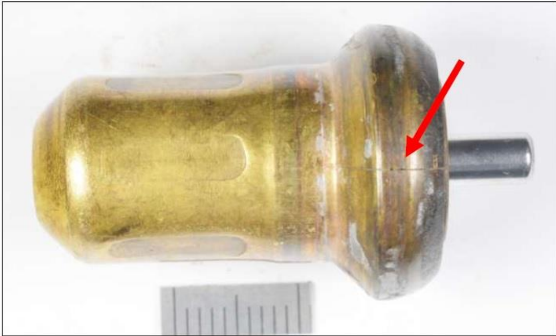
Obr. 18: Plášť termostatu s podélnou trhlinou vz. CP
