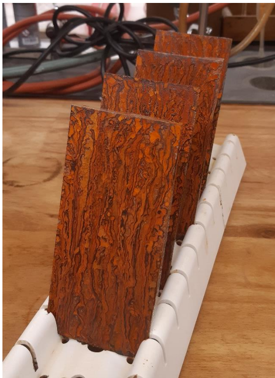
Obr. 35: Vzorky RE1-RE4 po ukončení zkoušky solnou mlhou
