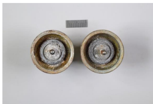
Obr. 36: Mosazný plášť vz. C1 a C2 s hliníkovým prvkem vz. A1 a A2 po korozní zkoušce
