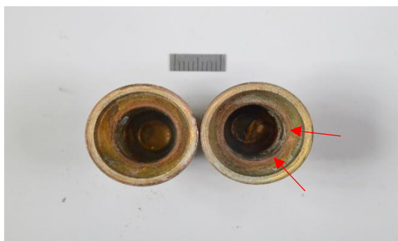
Obr. 37: Mechanicky očištěný mosazný plášť vz. C1 a C2 se stopami selektivní koroze
