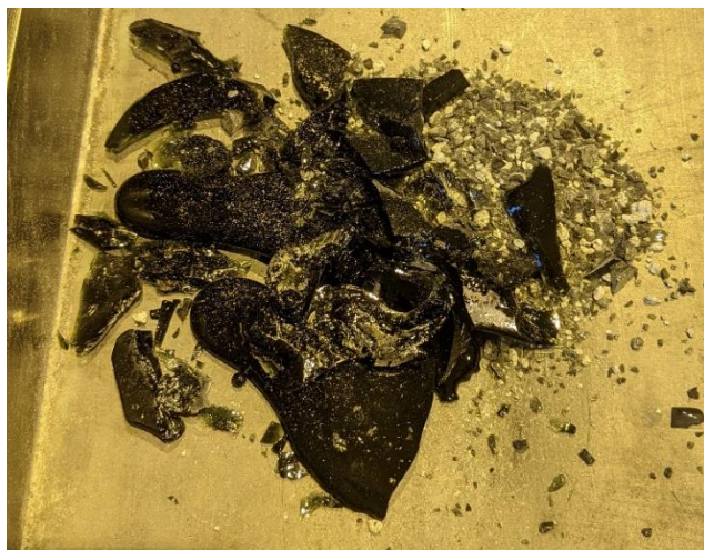
Obr. č. 20. Průběh drcení přetaveného boraxu na jemný prášek
