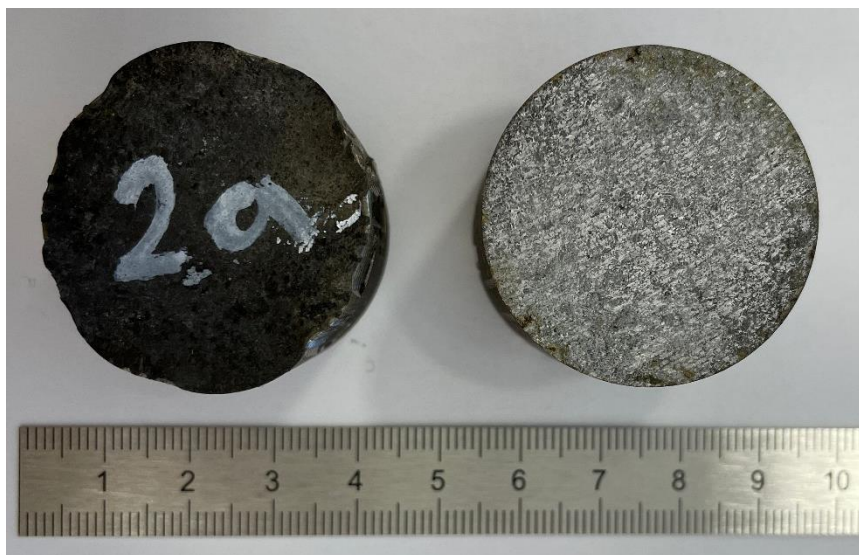
Obr. č. 16. Vzorek 2a po zkoušce krutem
