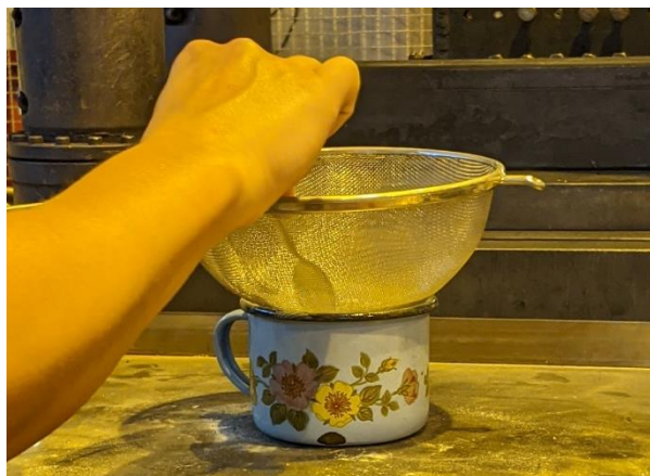
Obr. č. 21. Přesívání boraxového nadrceného prášku
