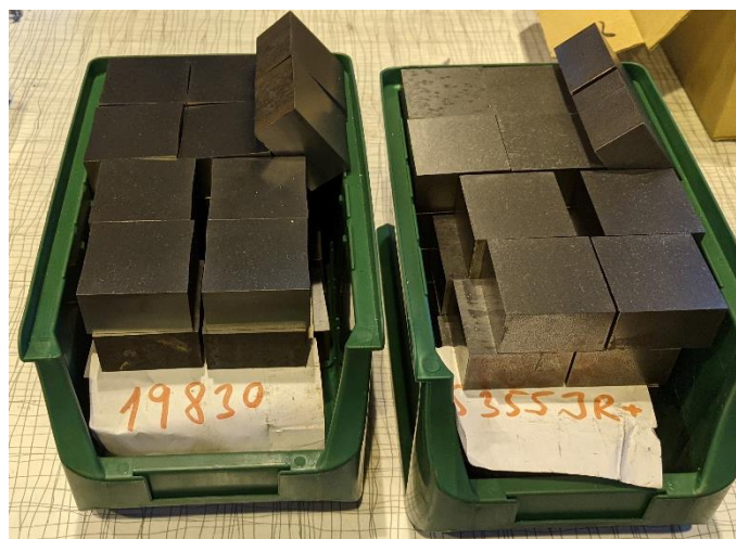
Obr. č. 23. Připravené destičky z materiálu ČSN 19 830 a ČSN 11 523
