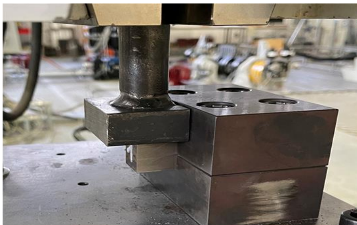
Obr. č. 28. Vzorek č. 1 uchycený do zkušebního stroje při stříhové zkoušce
