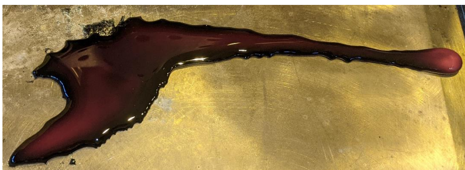
Obr. č. 19. Odlitý přetavený borax na ocelové podložce
