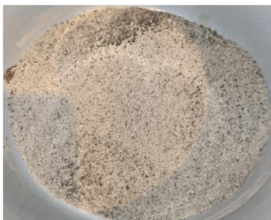
Obr. č. 22. Vzhled nadrceného prosetého boraxového prášku
