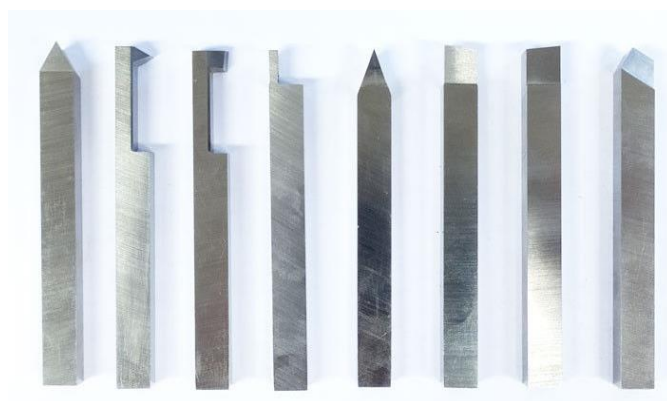
Obr. č. 9. Soustružnické nože celistvé z RO [31]
