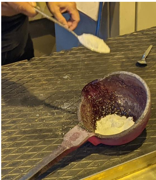
Obr. č. 18. Příprava boraxového prášku do licí lžice
