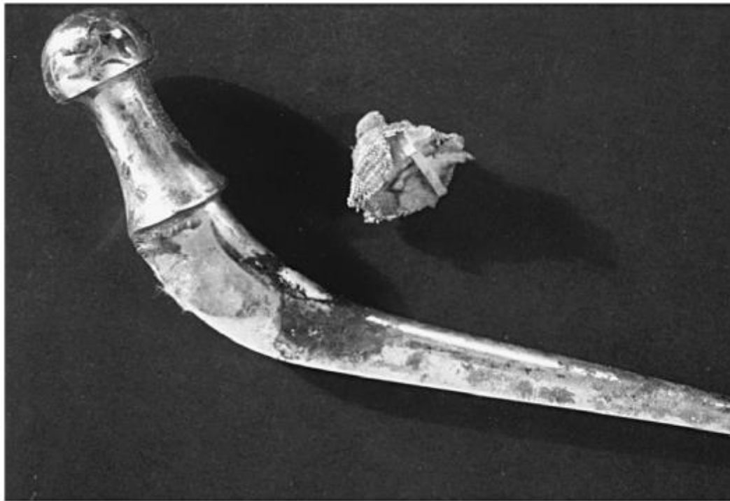
Obrázek 4 koroze implantátu z nerezové oceli [5]
