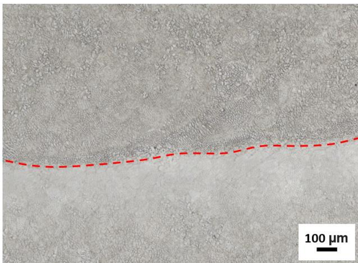
Obrázek 26 Vzorek XY, leptaný stav, zvětšení 50x, červeně hranice mezi stopami laseru
