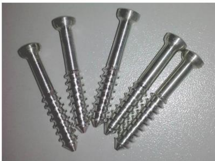
Obrázek 8 Šroub pro fixaci zlomených kostí vyrobený z hořčíkové slitiny [11]
