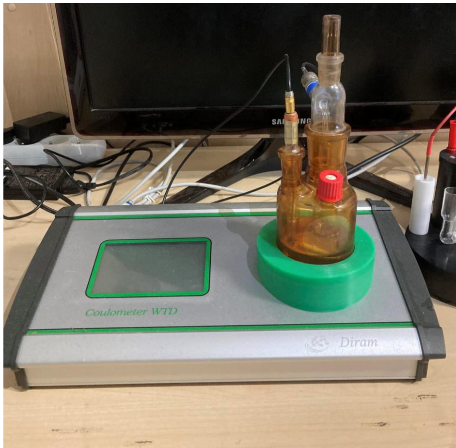
Obrázek 19: Zkušební nádoba pro měření obsahu vody
