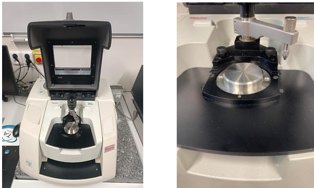
Obrázek 37: Přístroj Nicolet 380 (vlevo), měření ATR oleje (vpravo)
