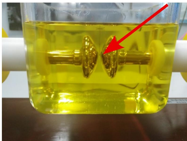
Obrázek 30: Vzniklé saze po přeskoku ve vzorku čisté řepky (vlevo), vysokonapěťové pracoviště (vpravo)
