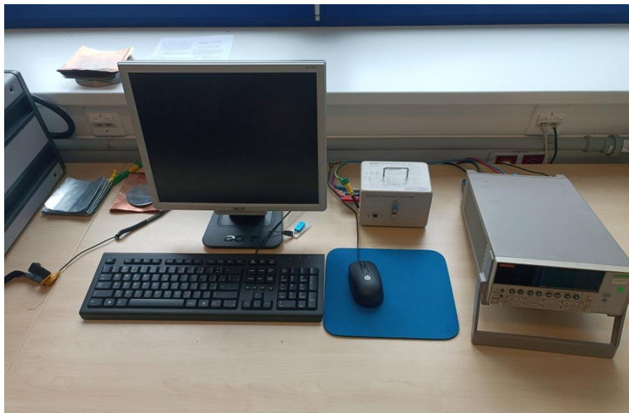
Obr. 56: Stanoviště pro měření rezistivity (zleva): se zkratovací knížkou, obslužným PC, elektrodovým systémem a elektrometrem se zabudovaným zdrojem napětí.
