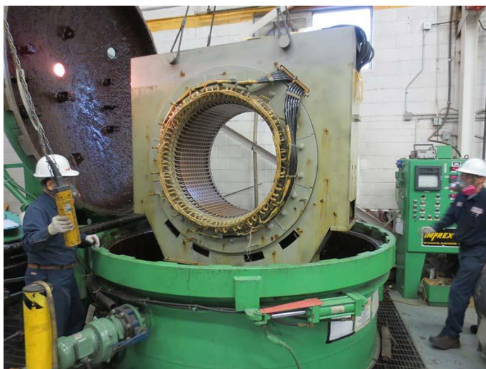
Obr. 2: Ukázka impregnace celého statoru (pomocí GVPI), převzato z [17].
