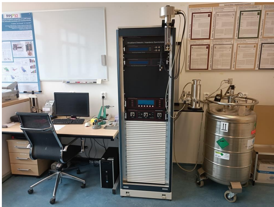
Obr. 58: Ukázka stanoviště pro měření permitivity a ztrátového činitele (BDS).
