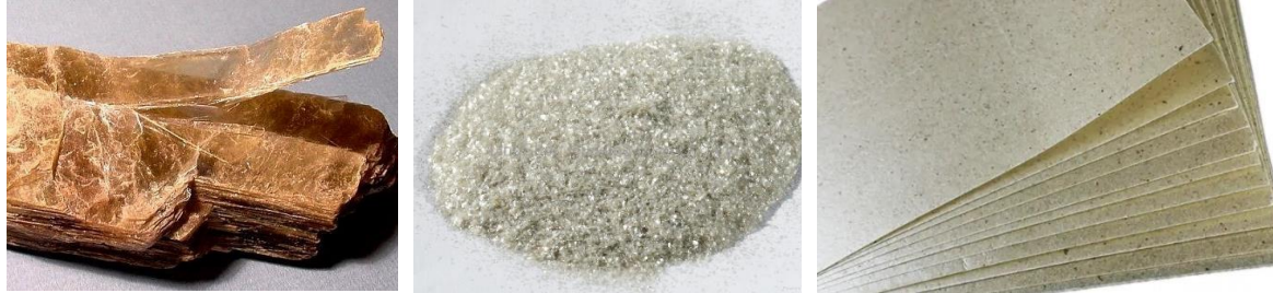
Obr. 41: Slída v různých stavech, zleva: slída v surovém stavu (převzato z [143]), slída v namletém stavu (převzato z [144]), slída ve formě slídového papíru (převzato z [145]).
