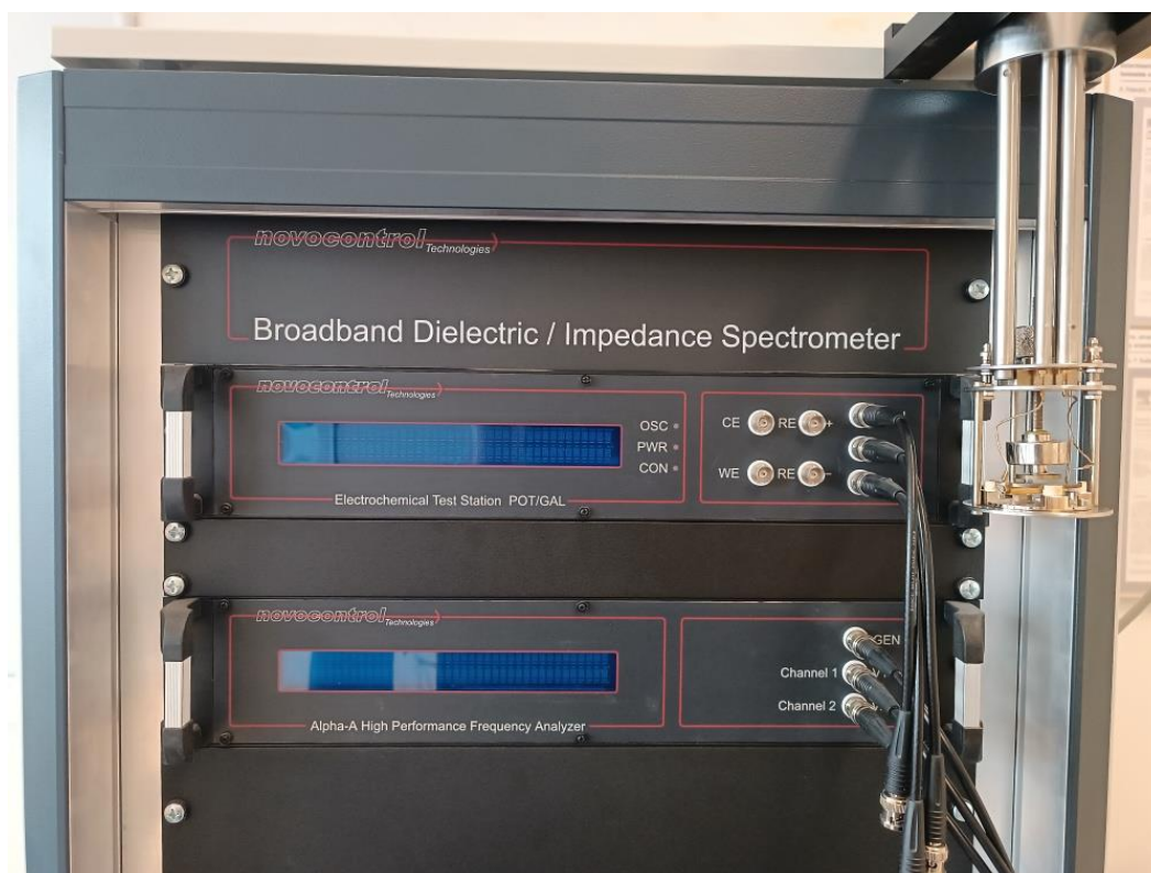
Obr. 59: Detail systému BDS s elektrodovým systémem pro upnutí vzorku.
