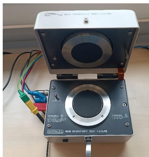
Obr. 57: Detail elektrodového systému Keithley 8009: a) s nákresem zapojení v zavřeném stavu, b) v otevřeném stavu.
