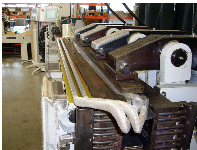
Obr. 1: Proces vytvrzování izolace cívky ve vyhřívaném lisu, převzato z [13].
