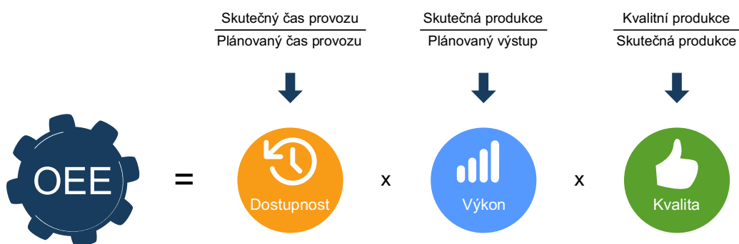
Obr. 8 - Výpočet OEE (převzato z [94])
