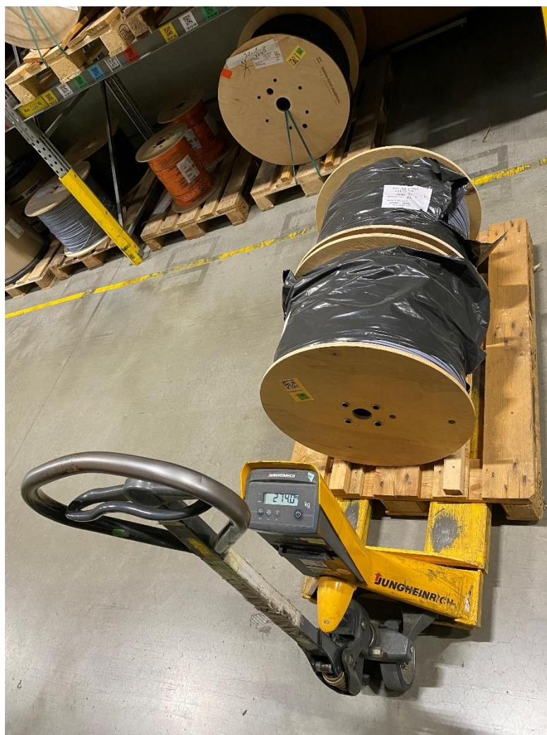
Obr. 29 - Vážení palet pomocí paletové vozíku s digitální váhou.
