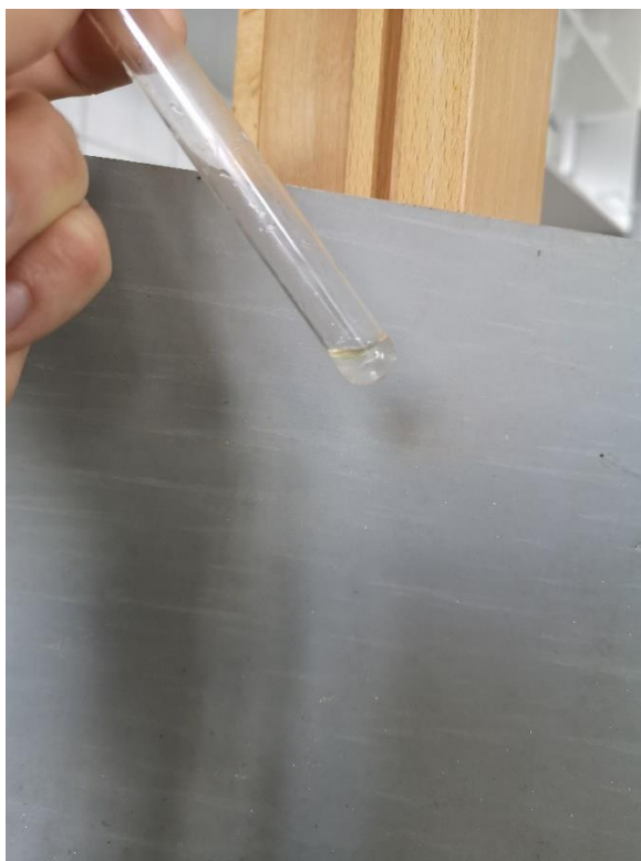
Obr. 30 Vytvoření dvou nemísitelných fází (benzen – voda)
