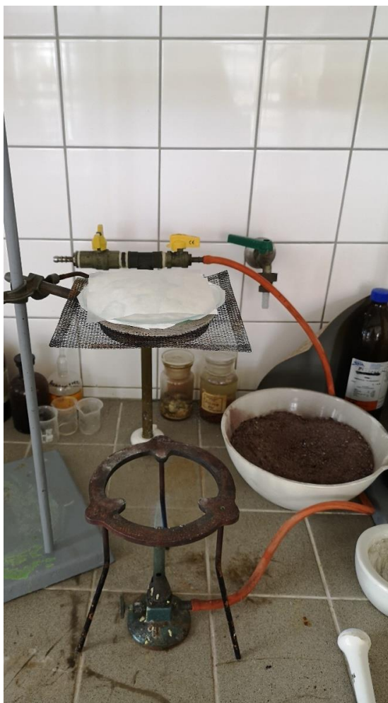
Obr. 23 Chlazení horního hodinového skla vlhkým filtračním papírem
