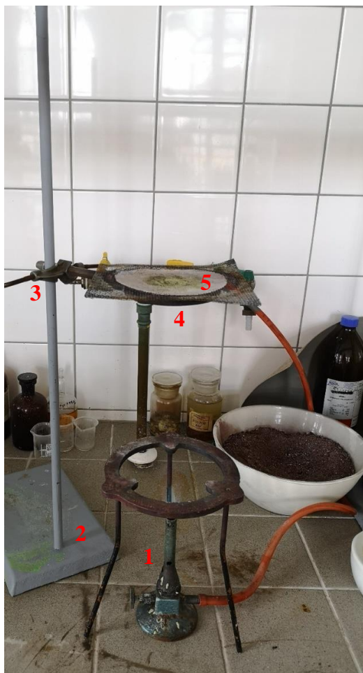
Obr. 20 Součásti aparatury k sublimaci naftalenu
