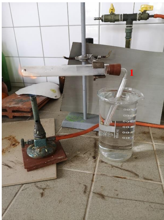
Obr. 28 Modifikovaná aparatura k přípravě benzenu
