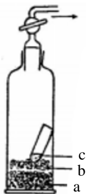
Obr. 19 Improvizovaný exsikátor (převzato z 3 ) a – sušidlo ( P_2O_5 ) b – skleněná vata c – vysoušená látka
