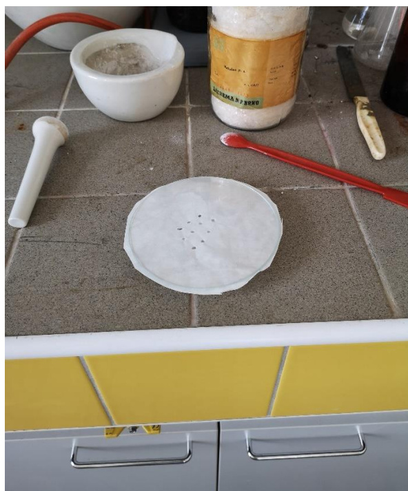
Obr. 22 Přiklopení perforovaného filtračního papíru druhým (horním) hodinovým sklem
