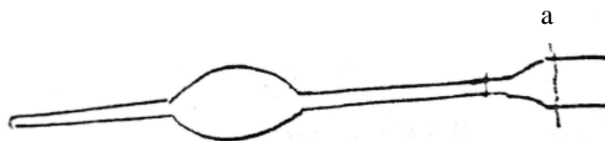
Obr. 6 Skleněný balónek s nálevkovitým rozšířením (převzato z 4 )
