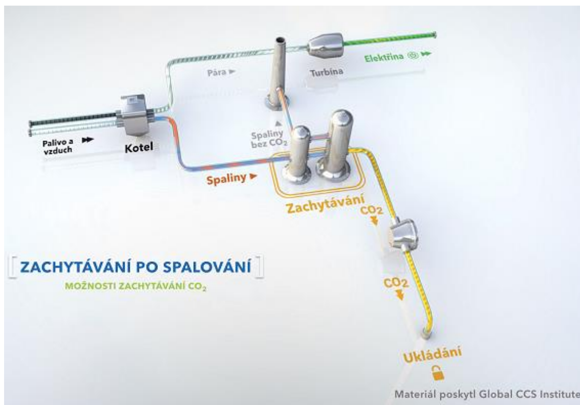
Obr. 16 Zachytávání CO 2 po spalování [44]
