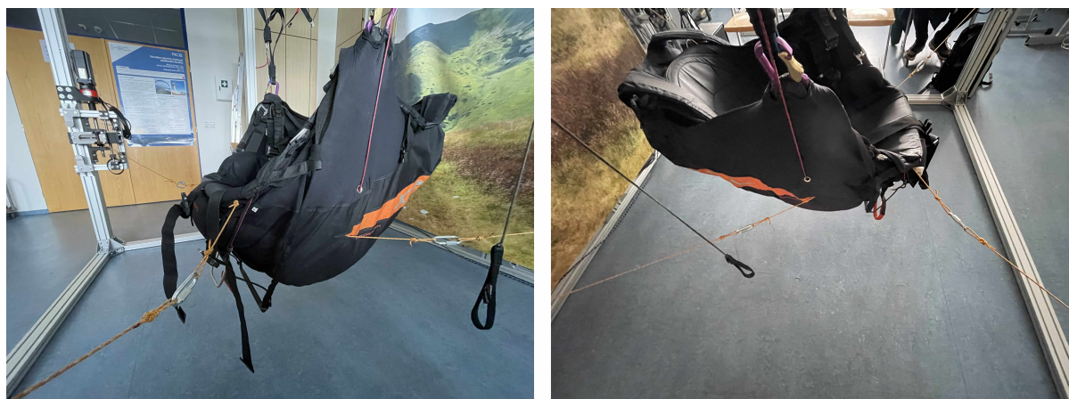
Obrázek 7: Upevnění posedu k lanům jednotlivých pohonů.
