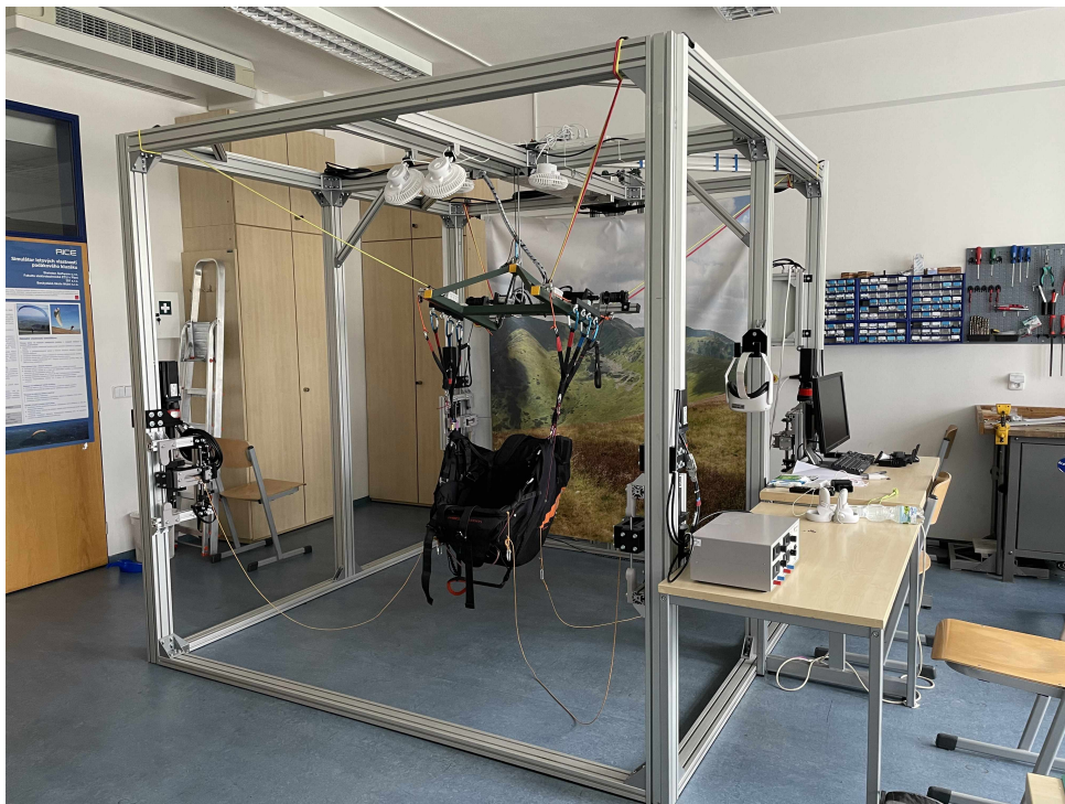
Obrázek 4: Konstrukce simulátoru padákového kluzáku.
