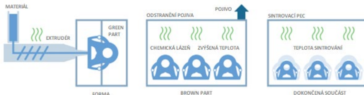
Obr. 3: Zjednodušené schéma procesu MIM [46]
