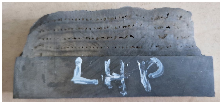
Obr. 37: Nespojitosti LMD návaru
