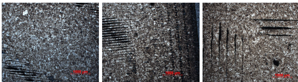
Obr. 31: Mikrostruktura – BHP – osa řezu y (vlevo), BVP – osa řezu y (uprostřed), BPV – osa řezu z (vpravo), zvětšení 25x
