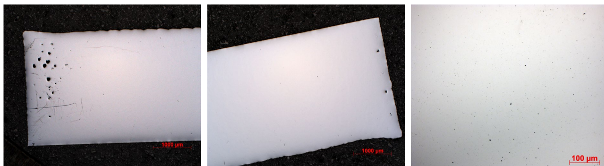
Obr. 34: Pórovitost vzorku SVP – osa řezu x, zvětšení 25x (vlevo), osa řezu y, zvětšení 25x (uprostřed), osa řezu z, zvětšení 200x (vpravo)
