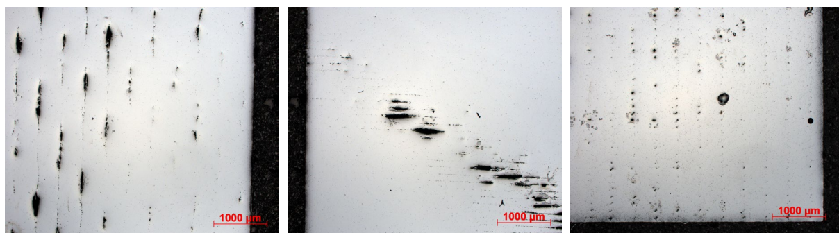
Obr. 26: Pórovitost vzorku BHP, osa řezu x (vlevo), osa řezu y (uprostřed), osa řezu z (vpravo), zvětšení 25x
