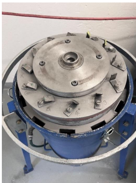
Obr. 8: Pracovní část zařízení pro hodnocení odolnosti proti eroznímu opotřebení pevnými částicemi
