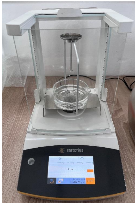
Obr. 6: Přesná váha Sartorius Quintix313 – 1CEU s vloženým držákem pro měření hustoty
