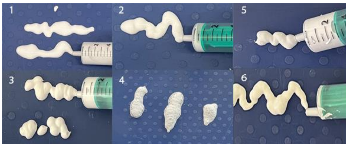
Obrázek 18 – Ověření vstřikovací schopnosti; 1: VS, 2: VS-P, 3: VS-P-C, 4: VS-P-TR, 5: VS-P-ND-, 6: VS-P-ND+
