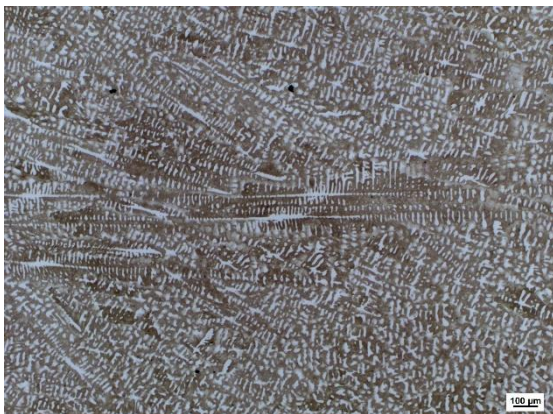
Obrázek 12: Mikrostruktura paty ingotu, tavba T22/032, zvětšení 50x
