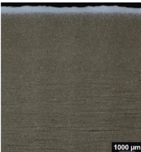
Obrázek 20: Mikrostruktura po válcování a žihání, tavba T22/033, zvětšení 50x
