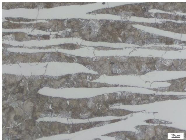
Obrázek 3: Mikrostruktura duplexní oceli s nízkou hustotou po válcování [5]
