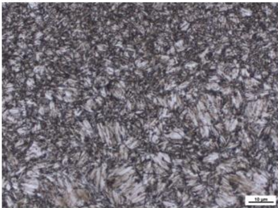
Obrázek 51: Sada mikrostruktur po válcování a následném TZ, s uvedenými teplotami popouštění, tavba T22/033, zvětšeno 1000x
