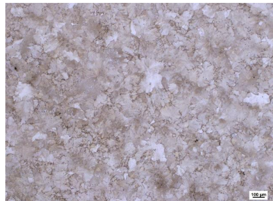
Obrázek 13: Mikrostruktura paty ingotu, tavba T22/033, zvětšení 50x
