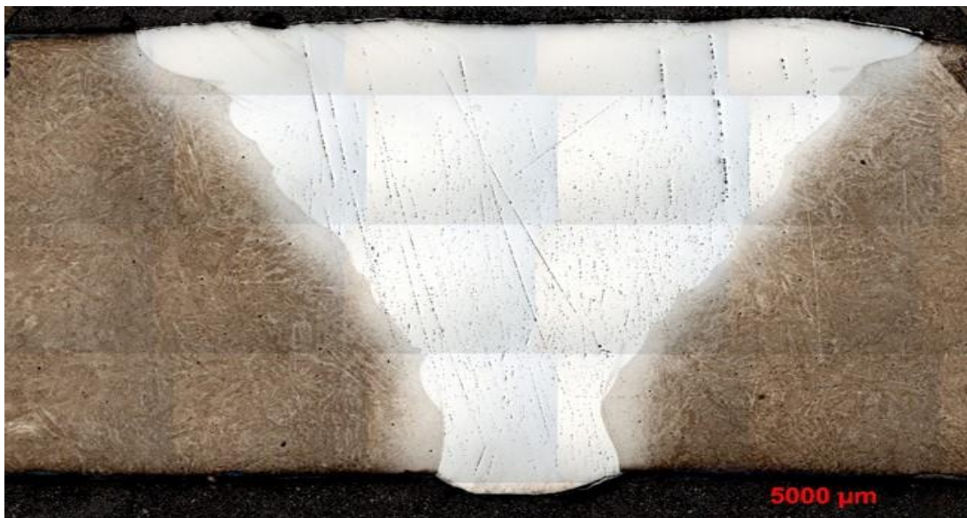
Obrázek 42: Vzorek COR2: Složený snímek svaru (leptáno Vilella Bain)
