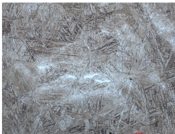
Obrázek 47: Vzorek COR2 – TOO s výskytem delta feritu, zvětšení 100x
