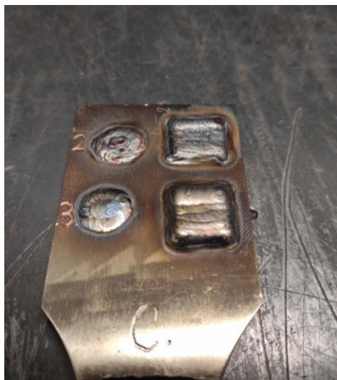
Obrázek 13: Zavařené vzorky z první sady – umělé vady
