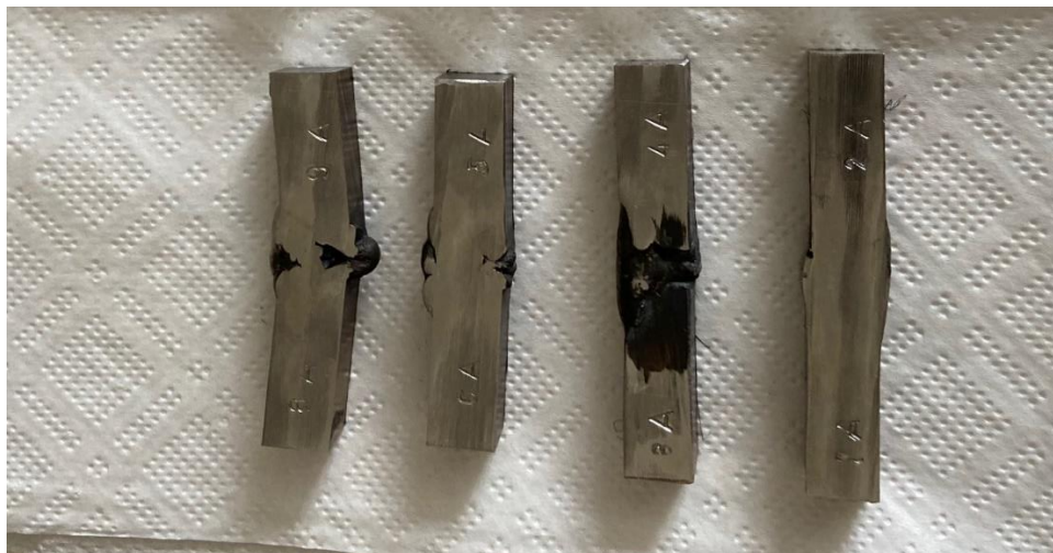
Obrázek 14: Vzorky ze druhé sady S2 po jejich svaření a nařezání
