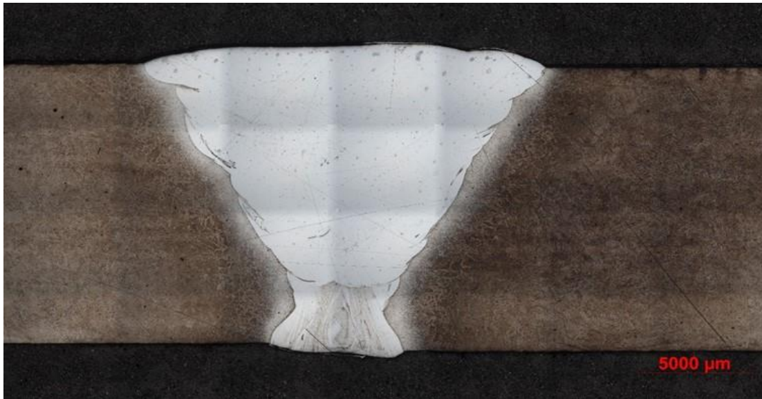
Obrázek 43: Vzorek COR3: Složený snímek svaru (leptáno Vilella Bain)
