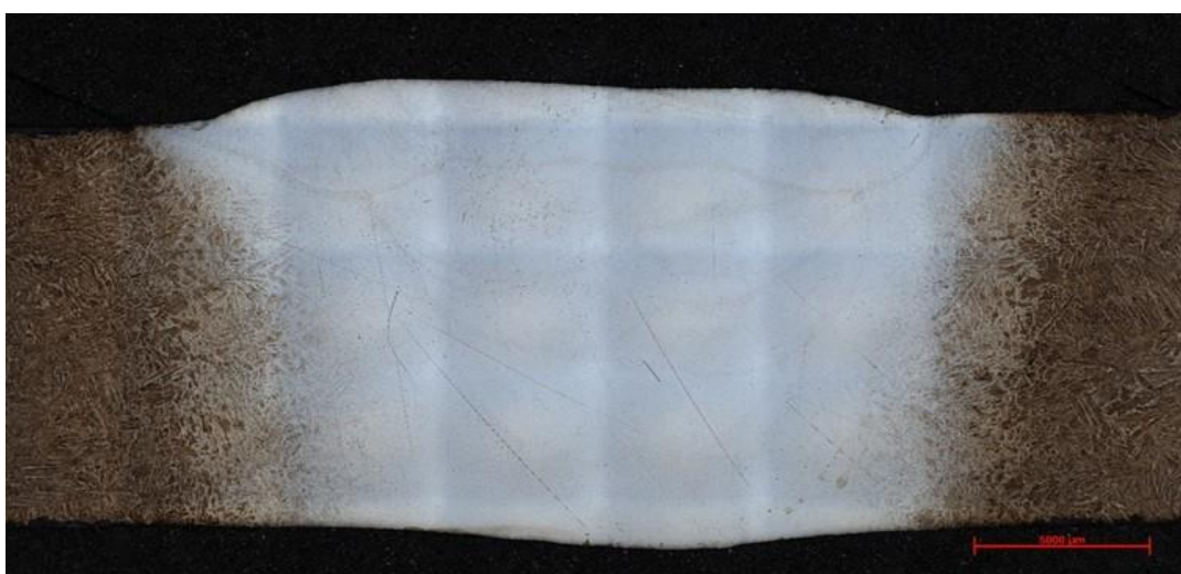
Obrázek 30: Vzorek 3A_4A: Složený snímek svaru (leptáno Vilella Bain)
