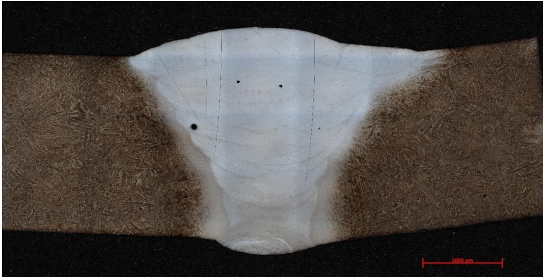
Obrázek 32: Vzorek 8A_9A: Složený snímek svaru (leptáno Vilella Bain)
