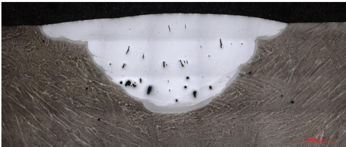
Obrázek 17: Složený snímek návaru - umělá vada (leptáno leptadlem Beraha II) - vzorek 3CI
