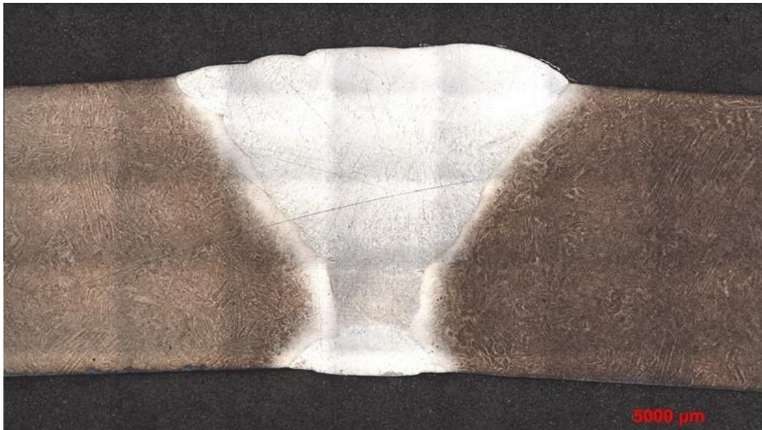
Obrázek 41: Vzorek COR1: Složený snímek svaru (Leptáno Vilella Bain)
