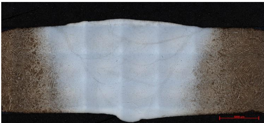
Obrázek 29: Vzorek 1A_2A: Složený snímek svaru (leptáno Vilella Bain)
