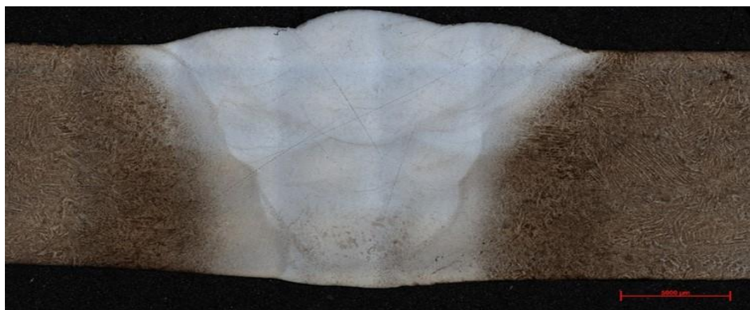
Obrázek 31: Vzorek 5A_6A: Složený snímek svaru (leptáno Vilella Bain)
