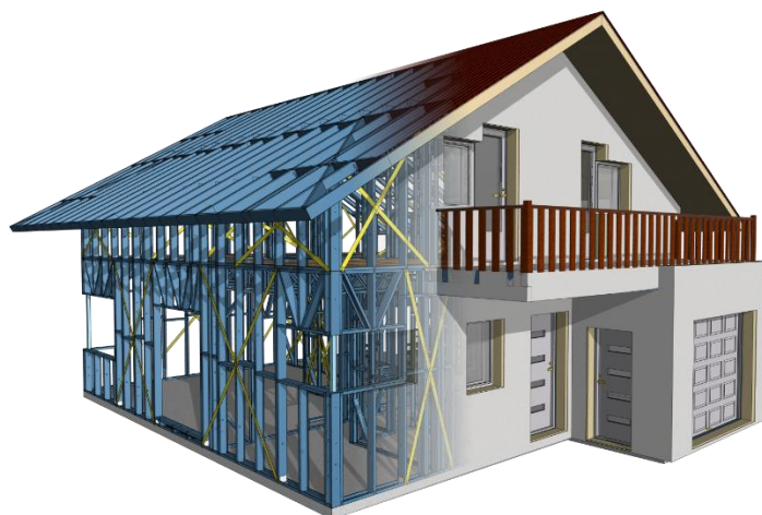
Obr. 63: vizualizace LGSF konstrukce domu [12]
