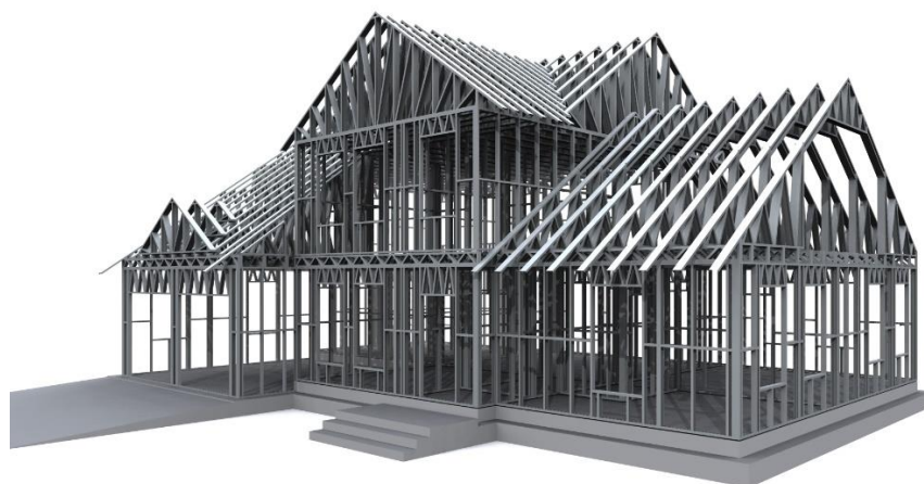
Obr. 57: LGSF konstrukce domu [12]
