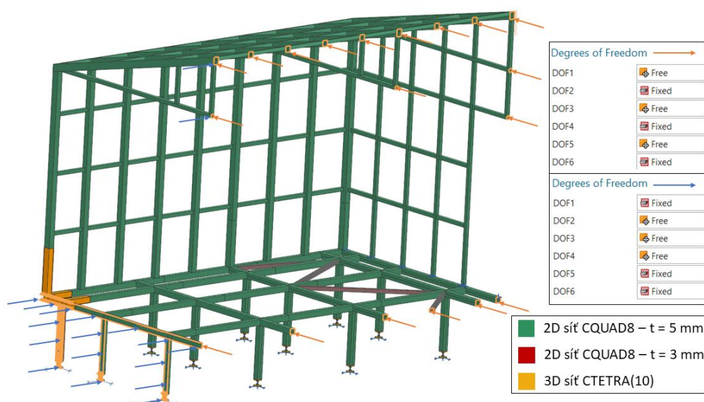
Obr. 39: Symetrie – definované vazby a použití sítě
