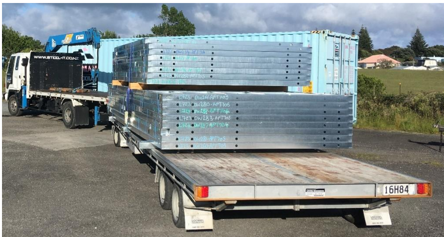
Obr. 68: Přeprava prefabrikovaných dílců – horizontálně
