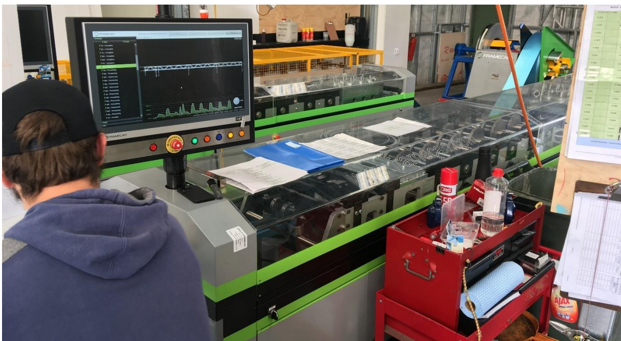
Obr. 62: Stroj FrameCAD F325iT-L – při provozu
