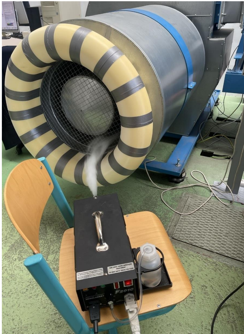
Obrázek 29 - Způsob sycení hlavního proudu částicemi
