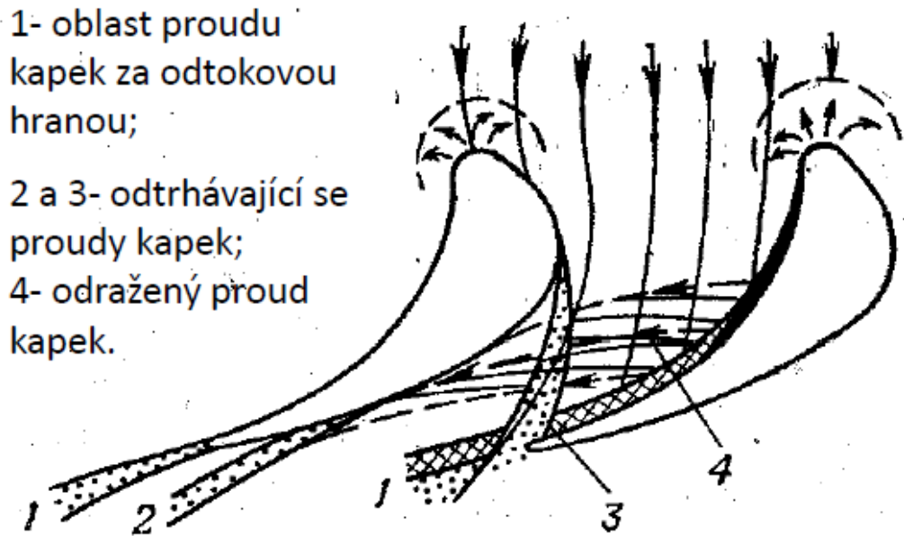
Obrázek 2 – rozdělení proudění kapalné fáze (1)
