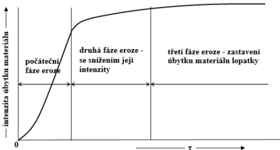
Obrázek 3 - Průběh eroze v čase
