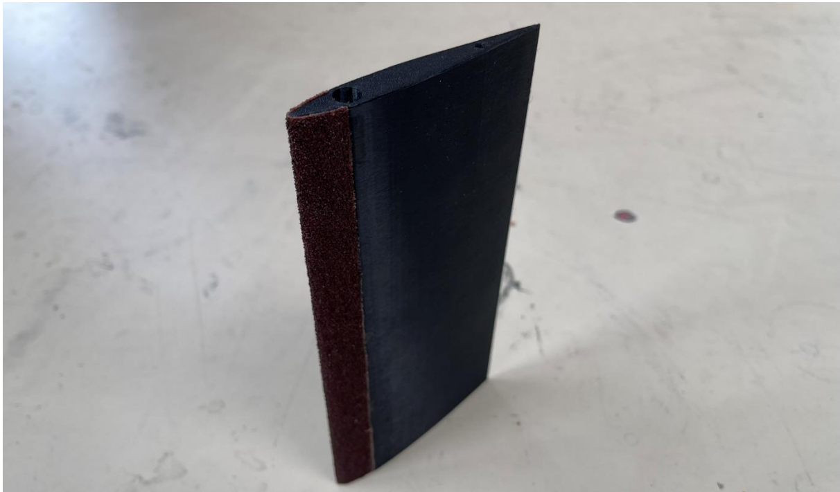
Obrázek 13 - Zkompletovaný model lehce porušené lopatky
