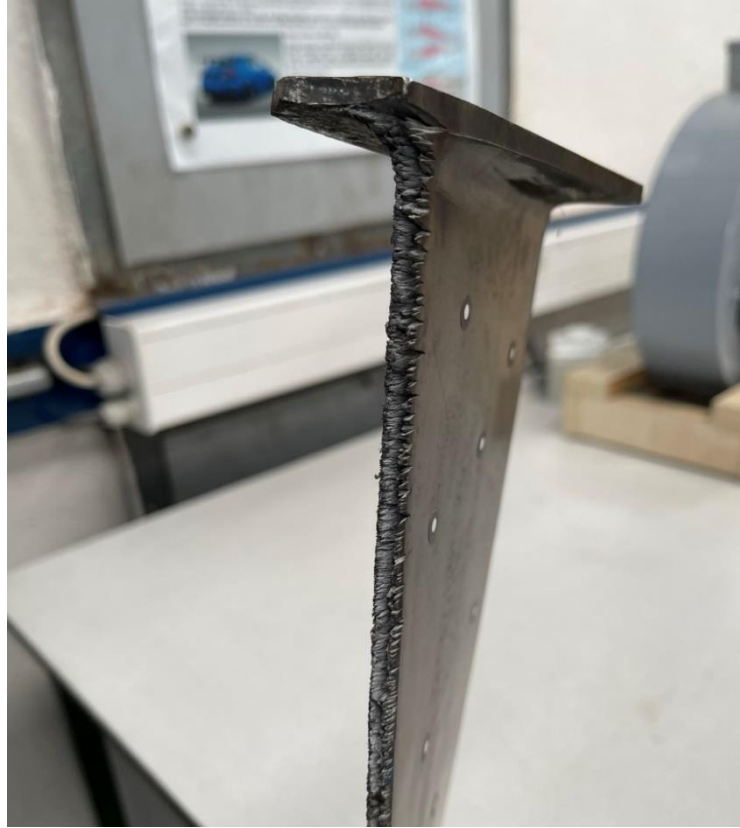
Obrázek 8 - erozně poškozená lopatka
