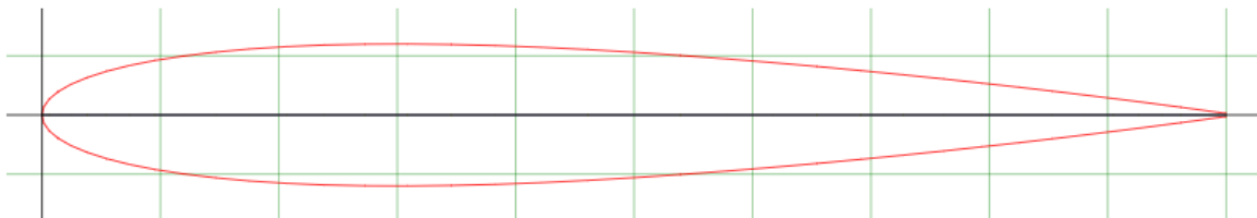
Obrázek 9 - základní profil lopatky NACA 0012 (17)
