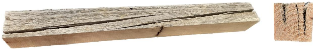
Obrázek 6.4 – Vyřazený vzorek z důvodu výskytu výsušných trhlin
