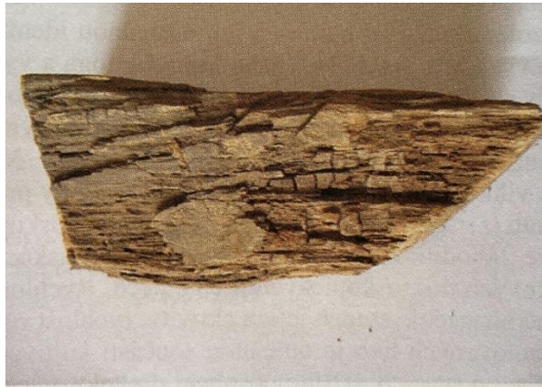
Obrázek 2.1 – Kostkovitý rozklad dřeva způsobený houbou hnědého tlení Zdroj: (Drdácký, 2015)
