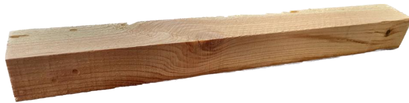
Obrázek 6.3 – Vyřazený vzorek z důvodu výskytu suku
