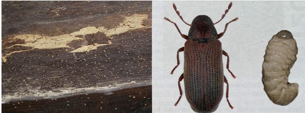
Obrázek 2.3 – Požerkové chodby a výletové otvory (vlevo) červotoče proužkovaného (vpravo) Zdroj: (Drdácký, 2015)
