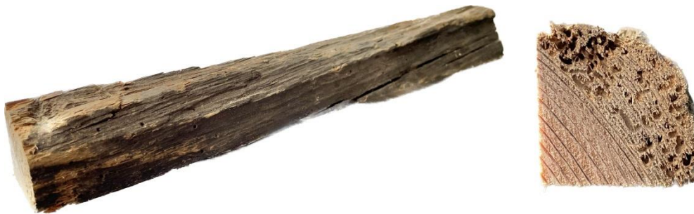
Obrázek 6.4 – Vyřazený vzorek z důvodu výskytu výsušných trhlin
