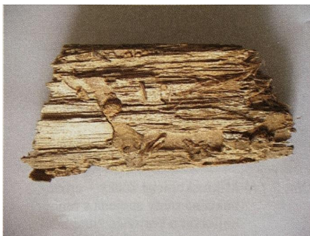
Obrázek 2.2 – Vlákňitost dlouhých třísek způsobená houbou bílého tlení Zdroj: (Drdácký, 2015)
