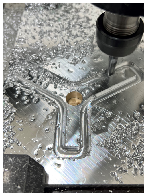
Obrázek 4.4: Schéma operace kontury vzorku v CAM programu a následné provedení
