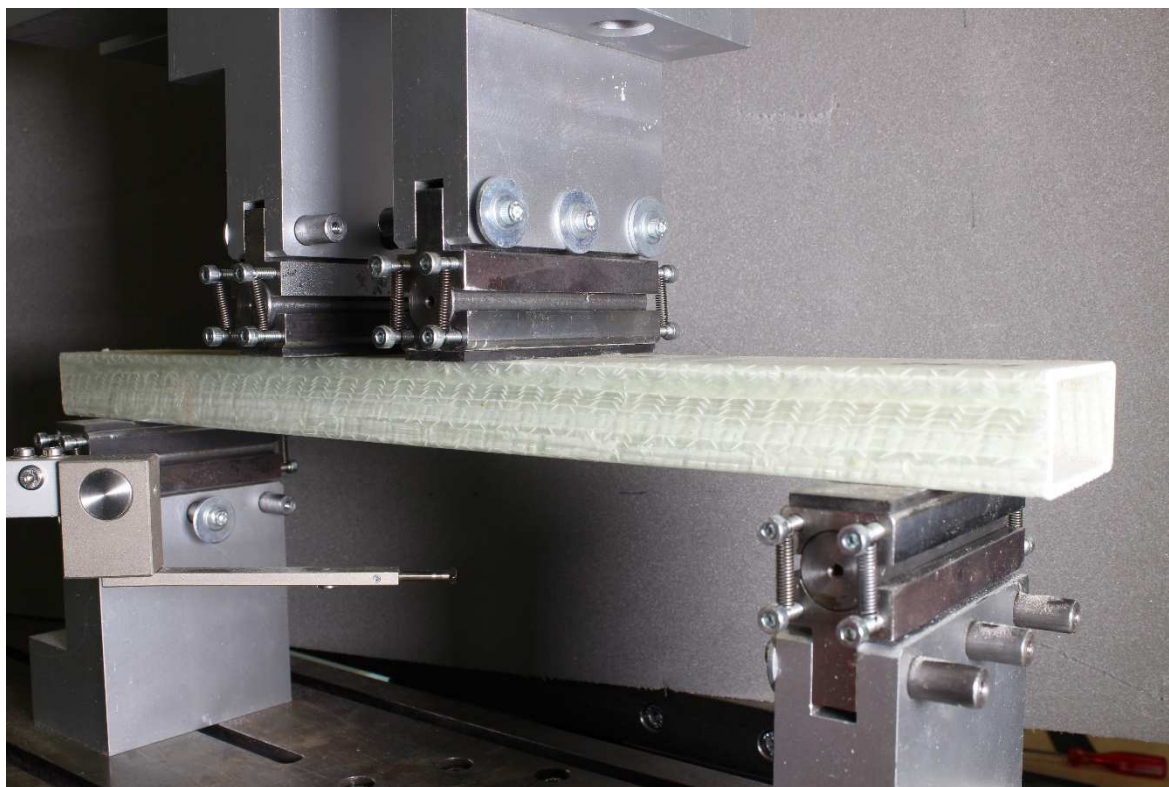
Obrázek 58 - KO_B_OL_1 před zkouškou [autor diplomové práce]
