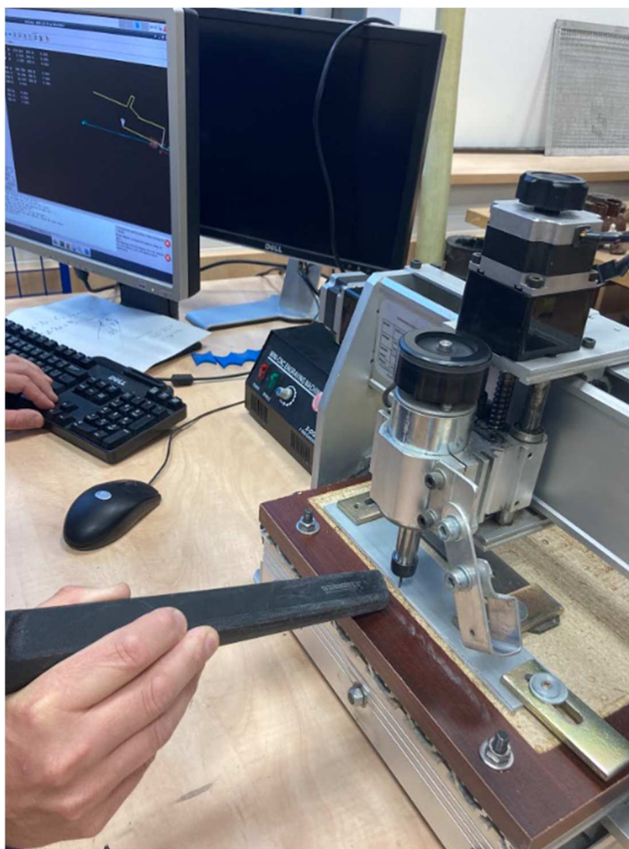
Obrázek 43 - Frézování kompozitních pásků do požadovaných rozměrů [autor diplomové práce]
