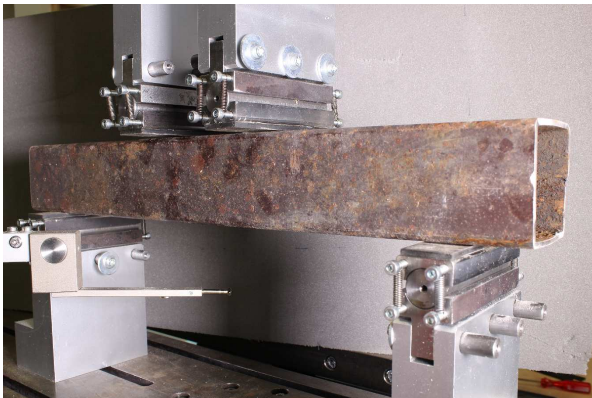
Obrázek 66 - OC_B_TR_2 před zkouškou [autor diplomové práce]
