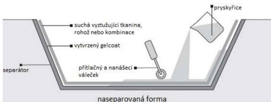
Obrázek 27 - Schéma ručního kladení [28]
