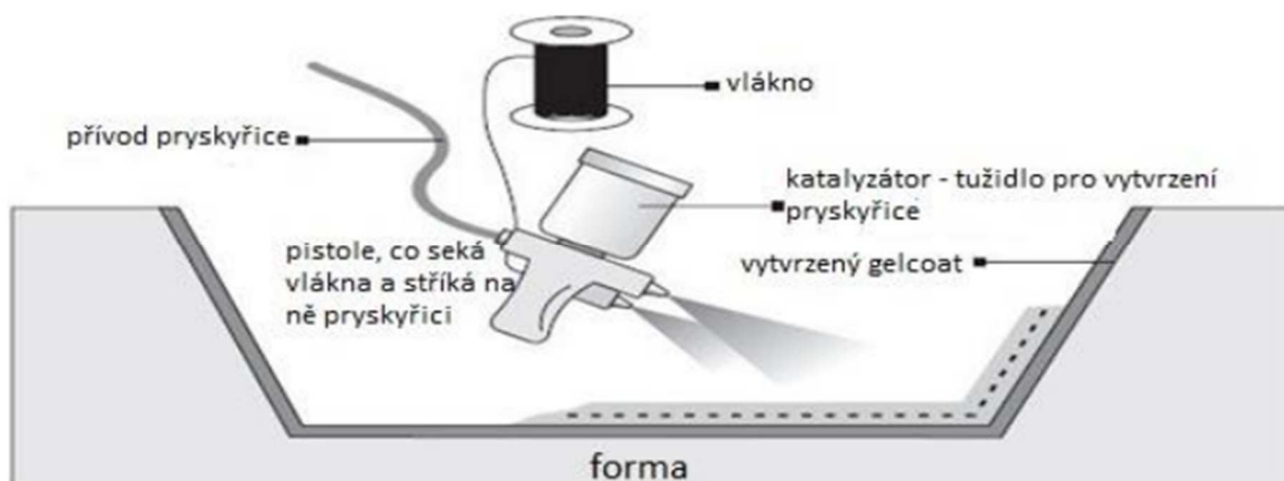
Obrázek 30 - Schéma stříkání [28]
