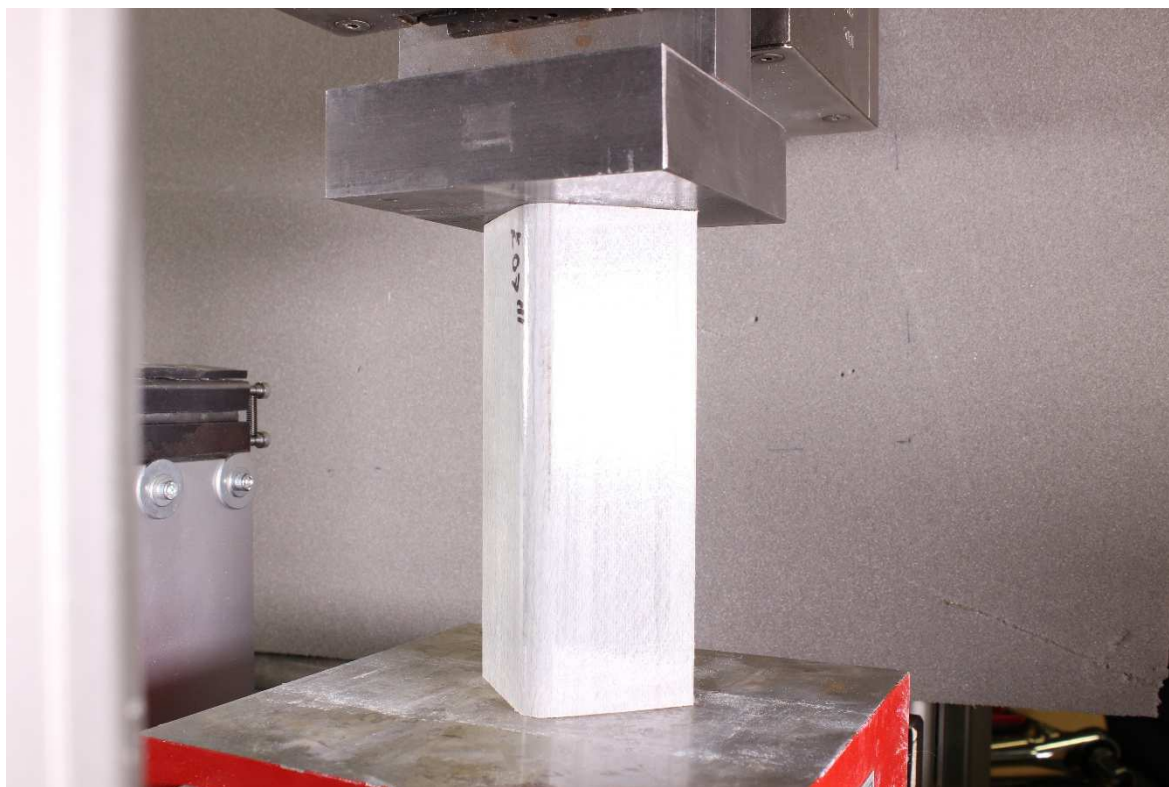
Obrázek 60 - KO_C_L_1 před zkouškou [autor diplomové práce]
