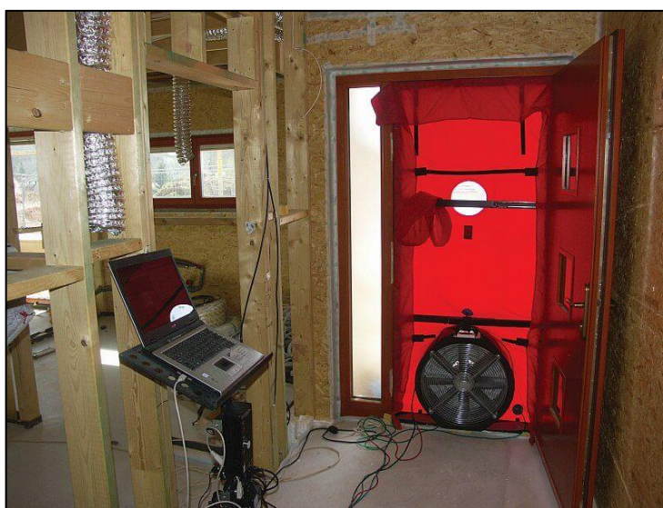
Obrázek 10 - Příklad provádění Blower-door testu Zdroj: [29]
