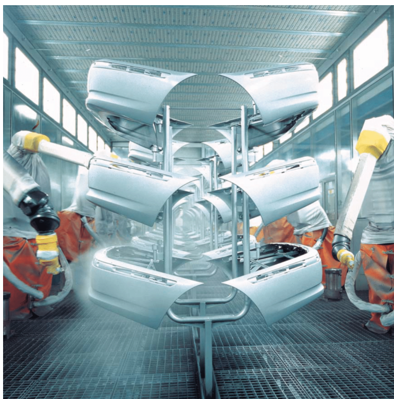
Obrázek 3.2: Lakování zadních nárazníků. Zdroj: Plastics Painting (2005).
